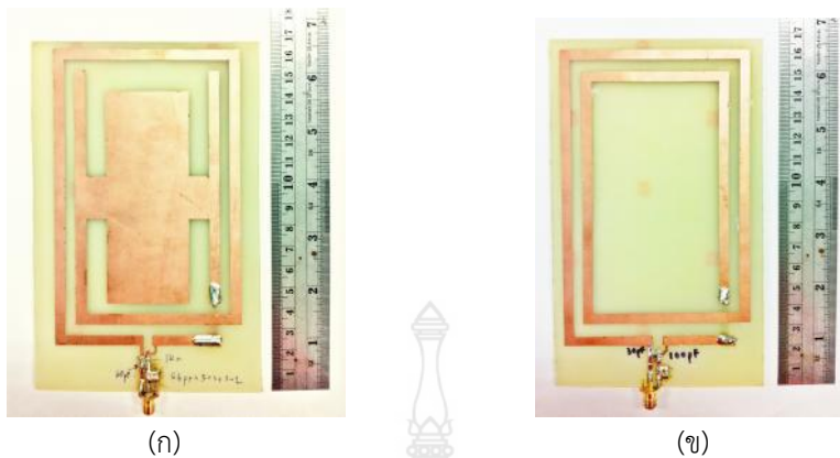
รูปที่ 6 สายอากาศต้นแบบ (ก) สายอากาศแผ่นพิมพ์แบบบ่วงขดควมวนรูปตัวเอช (ข) สายอากาศแผ่นพิมพ์แบบบ่วงขดควมวนรูปสี่เหลี่ยมตันแบบ
