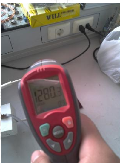
รูปที่ 11 วัดความร้อนอุณหภูมิของทองเหลืองหลังทำการเหนียวนำด้วยเครื่องวัดอุณหภูมิอินฟราเรด
