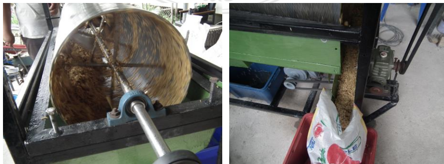
รูปที่ 2 การทำงานของเครื่องล้างข้าวเปลือกสำหรับเครื่องสีข้าวครัวเรือน
