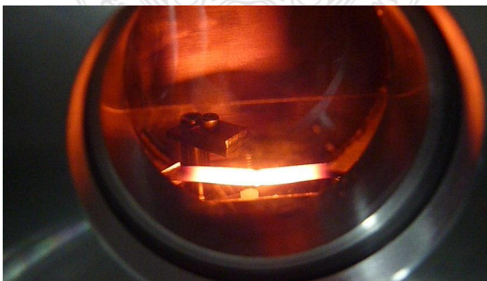
รูปที่ 6 ภาพขณะเคลือบสารอะลูมิเนียมที่หลอมเหลว
