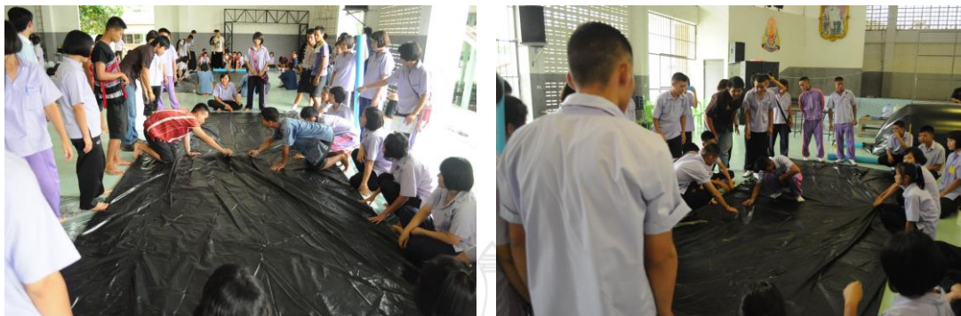
รูปที่ 3 ถุงที่ทำการทากาวและพร้อมในการติดตั้งชุดส่งแก๊ส
