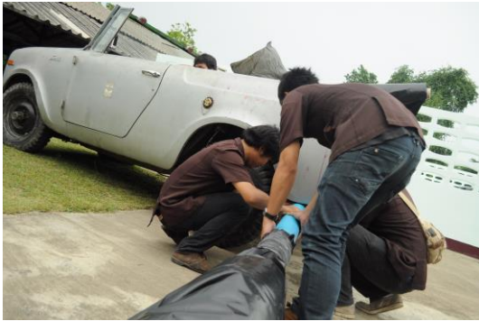
รูปที่ 6 ทดสอบรอยรั่วด้วยไอเสียจากรถยนต์
