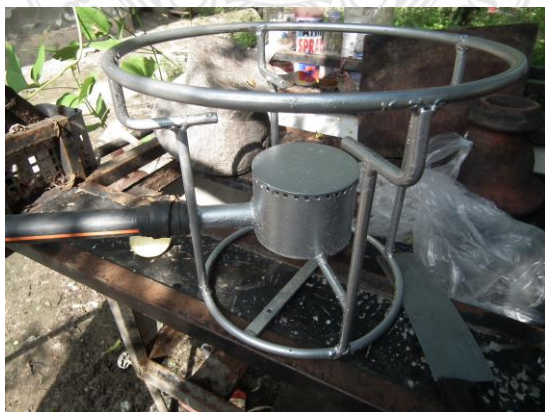
รูปที่ 10 การติดตั้งท่อส่งแก๊ส
