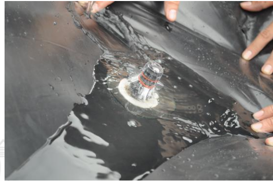
รูปที่ 6 ทดสอบรอยรั่วด้วยไอเสียจากรถยนต์
