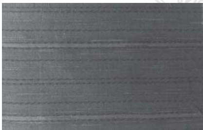
รูปที่ 3 ลวดลายที่เกิดจากการมัดย้อมเส้นฟุ้งพื้นผสม กับการใช้สีเส้นเส้นไหมยีน 3 ระดับ เข้ม กลาง อ่อน
