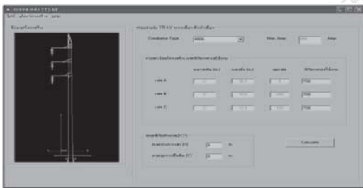
รูปที่ 16 หน้าต่างการบันทึกข้อมูลสำหรับการคำนวณความเข้มสนามแม่เหล็กของระบบสายส่งแรงสูง 115 kV วงจรเดี่ยวหนึ่งตัวนำ
