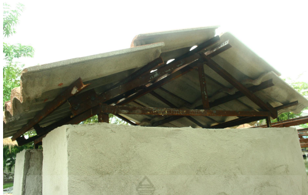
รูปที่ 4.20 การใช้งานผนังจำลองที่ก่อ-ฉาบบนอิฐบล็อกประสานหน้าดินขาว ผสมเศษกระดาชกล่องนมอัตราส่วน P0.80
