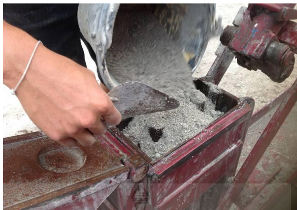
รูปที่ 3.14 การเทส่วนผสมลงในเครื่องอัดอิฐบล็อกประสานแบบมือโยก
