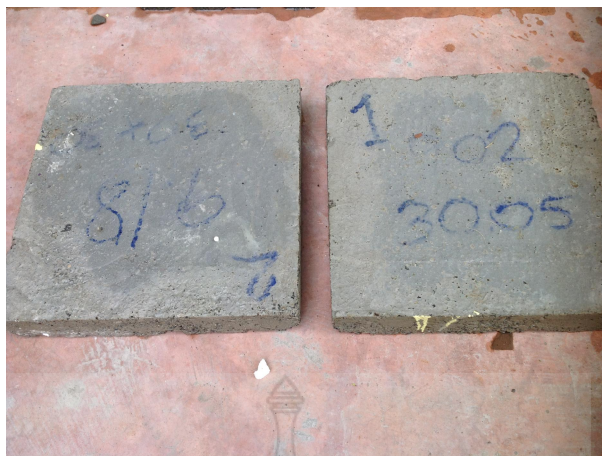
รูปที่ 3.24 อิฐบล็อกประสานหน้าดินขาวผสมเศษกระดาชกล่องนม สำหรับทดสอบสัมประสิทธิ์การนำความร้อน
