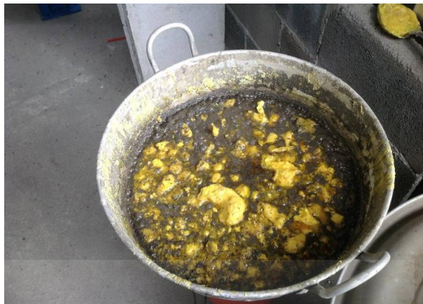
รูปที่ 3.21 กำมะถันที่ใช้เคลือบผิวหน้าอิฐบล็อกประสานสำหรับการทดสอบความต้านทานแรงอัด
