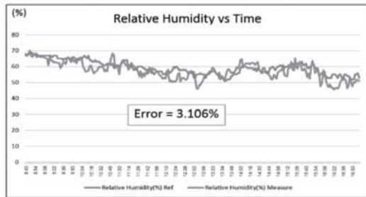
รูปที่ 10 ค่าผิดพลาดจากการวัดค่าความชื้นสัมพัทธ์ระหว่างสถานีวัดอากาศขนาดเล็กและสถานีวัดสภาวะอากาศอ้างอิง
