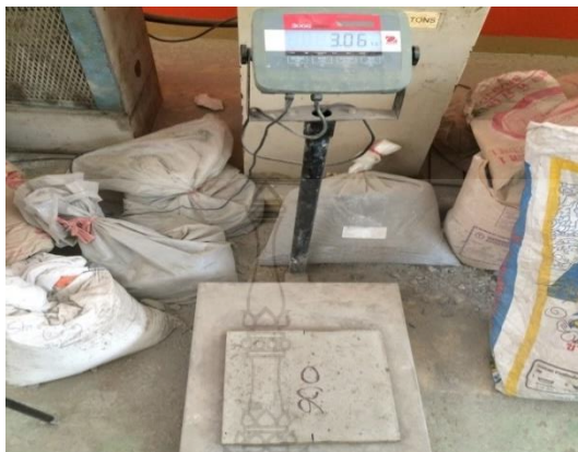
รูปที่ 3.25 การชั่งน้ำหนักแผ่นซีเมนต์บอร์ดจากกากกาแฟ
