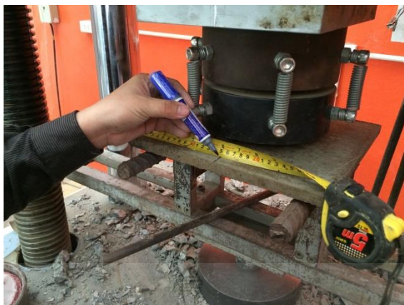
รูปที่ 3.28 การวางตำแหน่งของแผ่นซีเมนต์บอร์ดจากกากกาแฟ เพื่อทดสอบความต้านทานแรงดัดและมอดุลัสยืดหยุ่น
