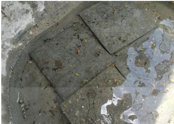
รูปที่ 3 การแช่น้ำแผ่นซีเมนต์บอร์ดจากกากกาแฟเพื่อทดสอบการพองตัว
