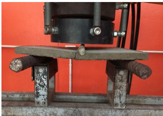
รูปที่ 3.31 การวิบัติของแผ่นซีเมนต์บอร์ดจากกาแกพจากน้ำหนักกด ขณะทดสอบความต้านทานแรงดัดและมอดุลัสยืดหยุ่น
