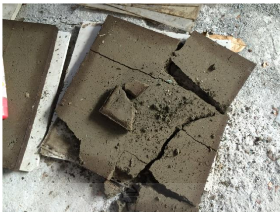
รูปที่ 3.13 แผ่นซีเมนต์บอร์ดที่มีปริมาณกากกาแฟมากเกินไปจนเกิดแตกหักเมื่อสัมผัส
