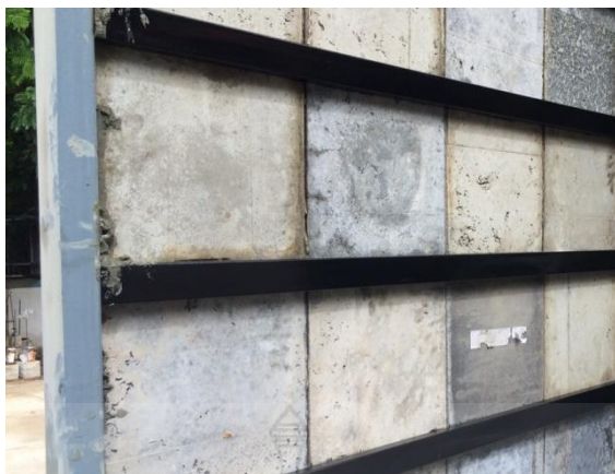
รูปที่ 4.24 ด้านหลังของผนังจำลองที่ติดตั้งแผ่นซีเมนต์บอร์ดจากกากกาแฟ
