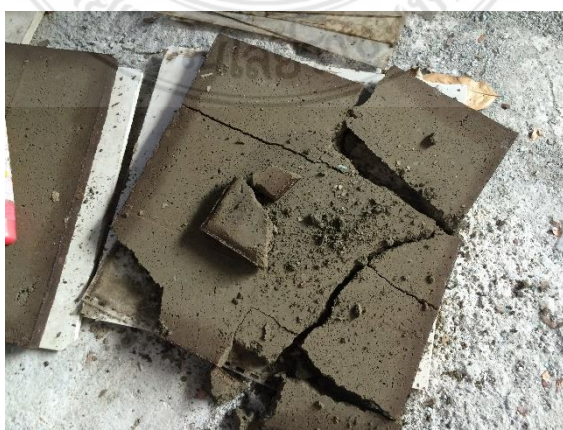
รูปที่ 4.1 การแตกหักของแผ่นซีเมนต์บอร์ดผสมกากกาแฟที่มีอัตราส่วนมากกว่า 1:0.10
