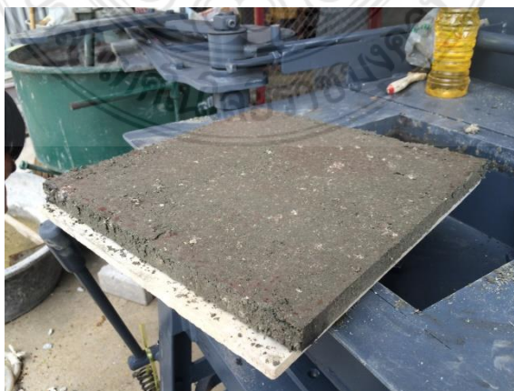
รูปที่ 3.22 การนำแผ่นซีเมนต์บอร์ดออกจากเครื่องอัด
