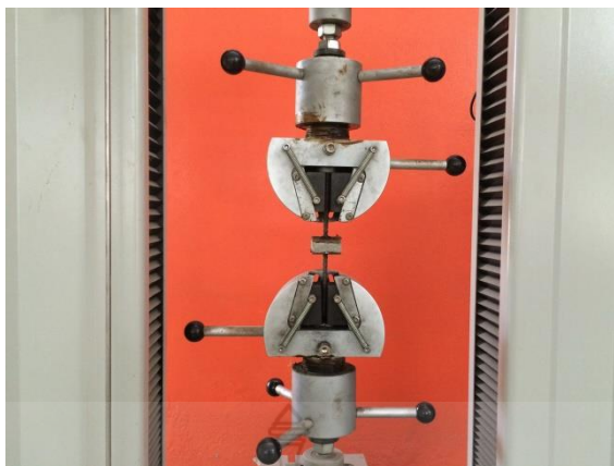
รูปที่ 3.40 การทดสอบความต้านทานแรงดึงตั้งฉากกับผิวหน้าของแผ่นซีเมนต์บอร์ดจากกากกาแฟ
