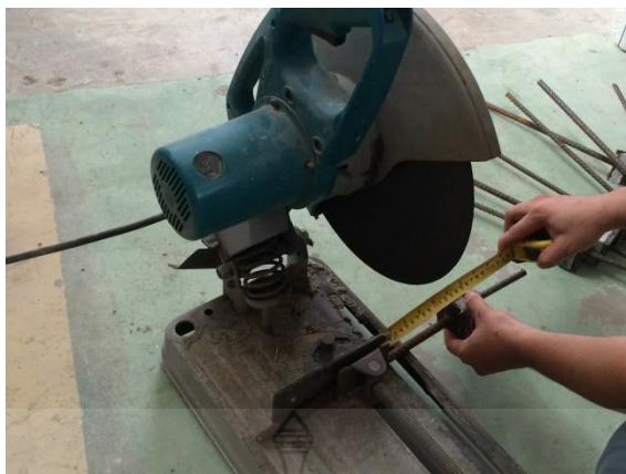
รูปที่ 3.34 การตัดเหล็กเพื่อใช้ในการทดสอบความต้านทานแรงดึงตั้งฉากกับผิวหน้าแผ่นซีเมนต์บอร์ดจากกากกาแฟ
