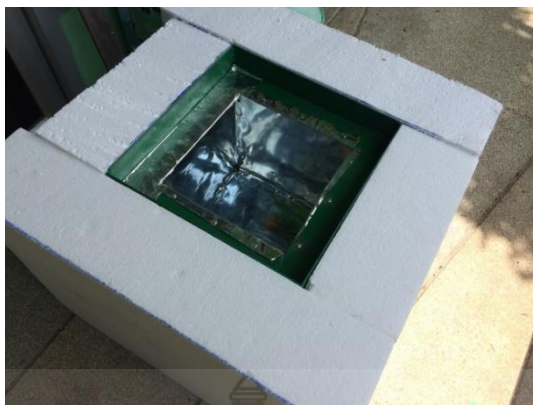
รูปที่ 3.11 ห้องจำลองสำหรับติดตั้งแผ่นวัสดุทดสอบเสียง
