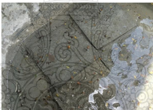
รูปที่ 3.26 การนำแผ่นซีเมนต์บอร์ดจากกากกาแฟไปแช่น้ำเพื่อทดสอบการพองตัว
