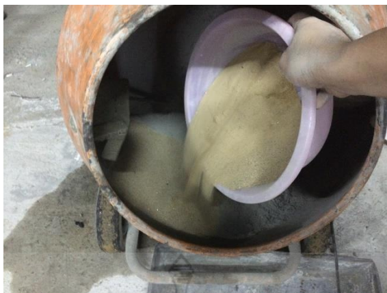
รูปที่ 3.15 การผสมปูนซีเมนต์ปอร์ตแลนด์ประเภท1 เข้ากับทรายละเอียด
