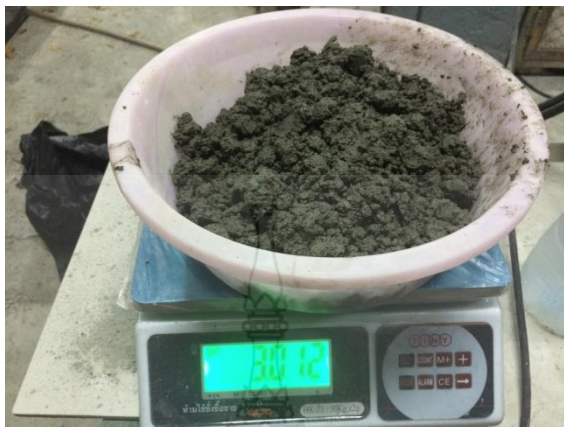
รูปที่ 3.18 การชั่งน้ำหนักส่วนผสมสำหรับเทลงในเครื่องอัดขึ้นรูปแผ่นซีเมนต์บอร์ด
