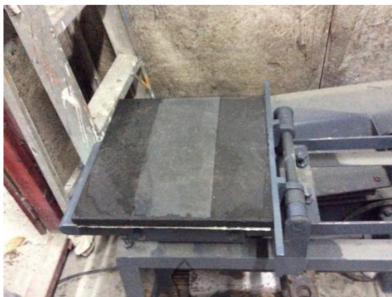
รูปที่ 3.23 การพลิกแผ่นซีเมนต์บอร์ดจากกากกาแฟด้วยแท่นพลิก
