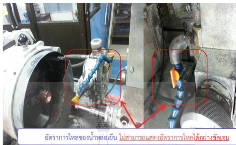
ภาพ 3.10 อัตราการไหลของน้ำหล่อเย็น ไม่สามารถแสดงอัตราการไหลได้อย่างชัดเจน ที่มา: บริษัท อาร์แอนด์ดีพีริซัน จำกัด
