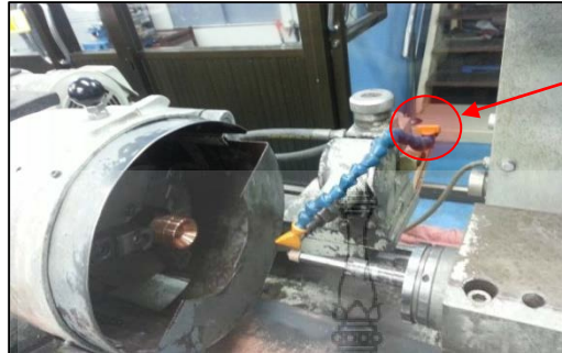
ภาพที่ 7 ตำแหน่งในการติดตั้ง Water Flow Sensor เพื่อตรวจวัดอัตราการไหลของน้ำหล่อเย็น
