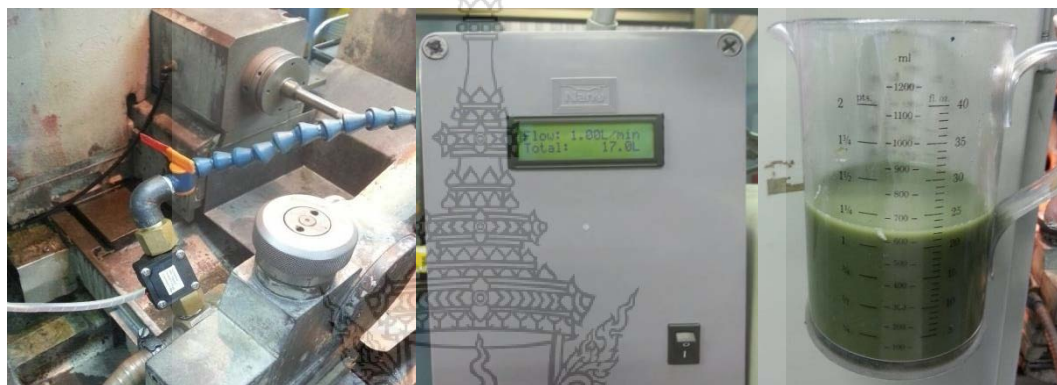
ภาพ 3.14 แสดงการทดสอบความเที่ยงตรงของอุปกรณ์เพื่อกำหนดอัตราการไหลของน้ำหล่อเย็น
