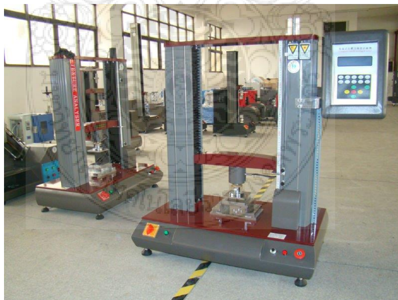
ภาพ ข 14 เครื่องมือทดสอบคุณสมบัติทางกายภาพ การต้านแรงกด
