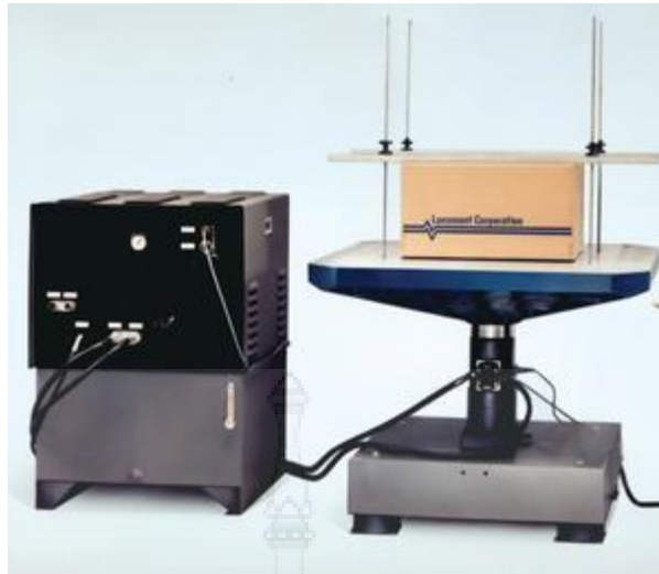
ภาพ ข 15 เครื่องมือทดสอบคุณสมบัติทางกายภาพ การต้านแรงเส้นสะท้อน
