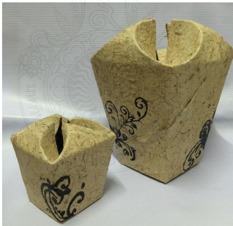
ภาพที่ ข.18 แสดงลักษณะของบรรจุภัณฑ์จากกระดาษผสมสารสกัดไบโอฟริง แบบที่ 2
