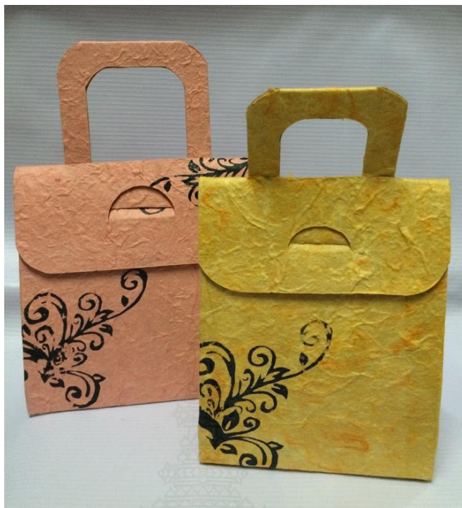
ภาพที่ ข.25 แสดงลักษณะของบรรจุภัณฑ์จากกระดาษผสมสารสกัดใบฝรั่ง แบบที่ 7
