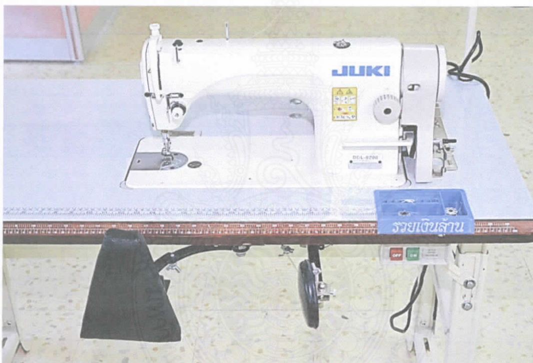
ภาพที่ 3.13 จักรเย็บผ้าอุตสาหกรรมเข็มเดียวสำหรับคนพิการขาที่ติดตั้งอุปกรณ์แล้ว (ด้านบน)
