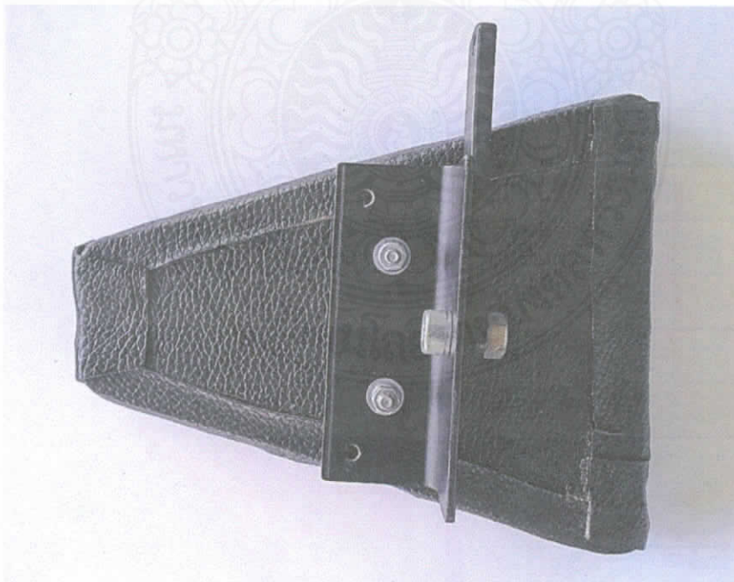
ภาพที่ 3.2 ชุดเบาะอุปกรณ์การขับเคลื่อนคลัชมอเตอร์จักรเย็บผ้าอุตสาหกรรม (ส่วนบน)
