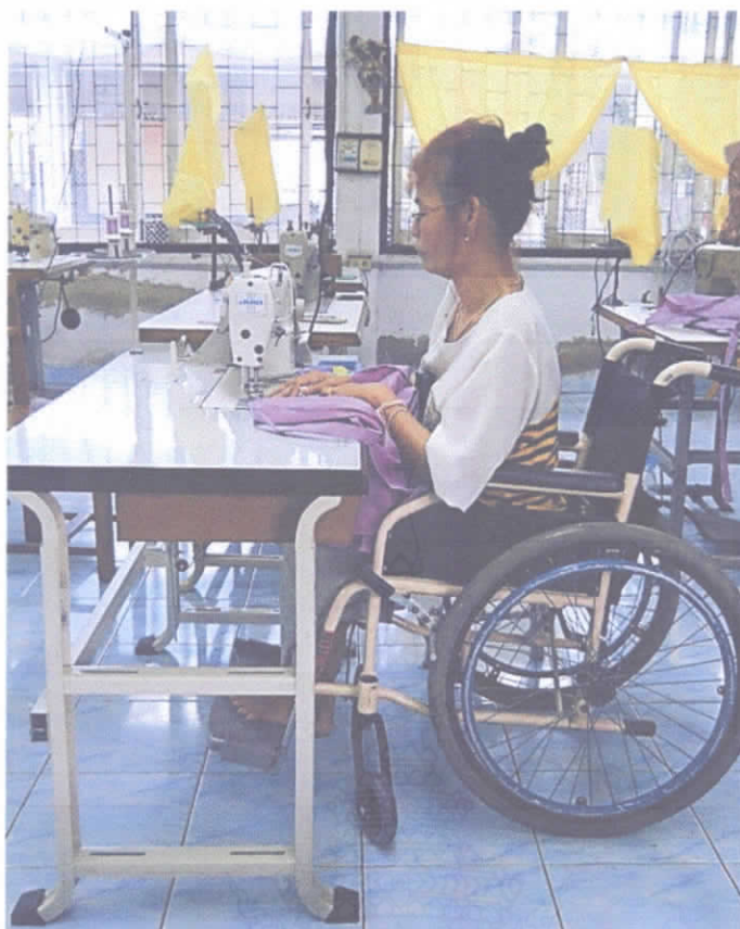
ภาพที่ 4.2 แสดงการใช้งานจักรเย็บผ้าอุตสาหกรรมโดยคนพิการขาตั้งแต่เกิด (ด้านข้าง)
