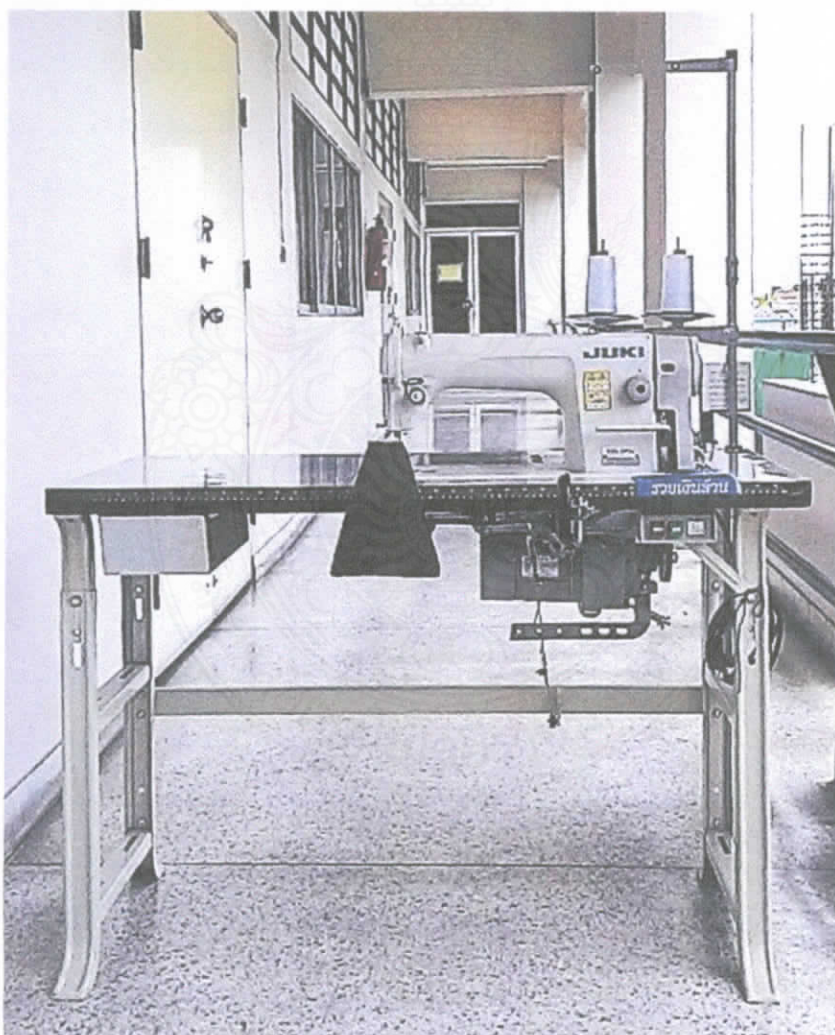
ภาพที่ 3.12 จักรเย็บผ้าอุตสาหกรรมสำหรับคนพิการขาที่ติดตั้งอุปกรณ์แล้ว
