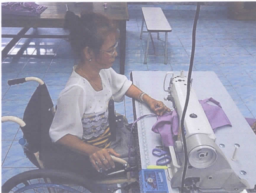
ภาพที่ 4.8 แสดงการใช้งานมือดันอุปกรณ์เพื่อยกเท้าทับผ้าของผู้พิการขาซ้าย ไมมีแรง
