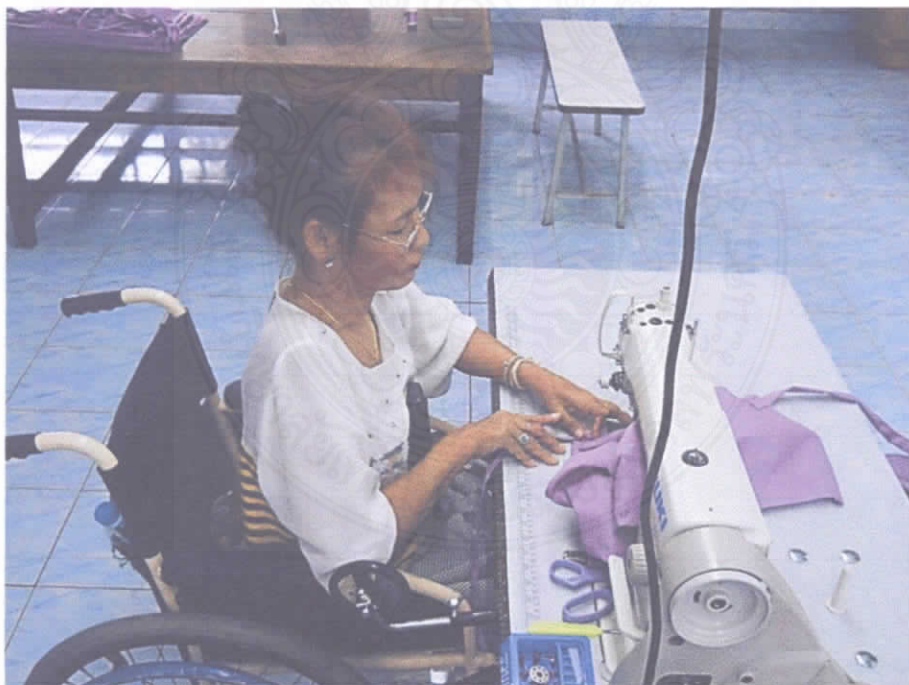
ภาพที่ 4.9 แสดงการใช้งานข้อศอกดันอุปกรณ์เพื่อยกเท้าทับผ้าของผู้พิการขาซ้าย ไมมีแรง
