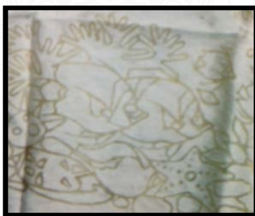
ภาพที่ 2.3 เส้นเทียนที่เกิดจากแม่พิมพ์ ที่มา: ธวัชชัย (2537)
