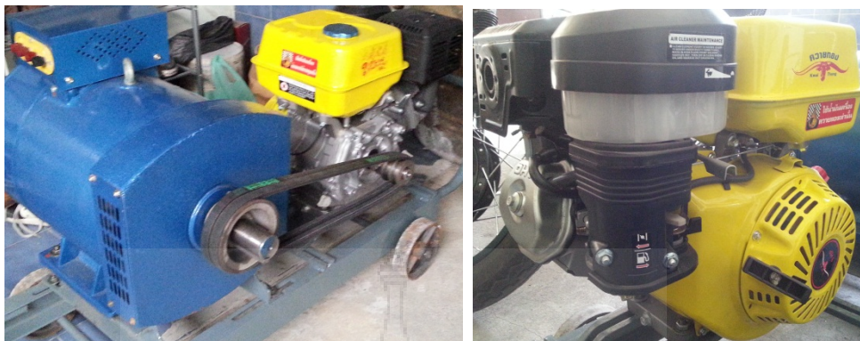
รูปที่ 3.3 เป็นชุดเครื่องกำเนิดไฟฟ้ากระแสสลับที่ได้จากการออกแบบและประกอบสร้าง
