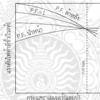
รูปที่ 2.32 กระแสอาเมเจอร์ที่ P.F. ต่างๆ
