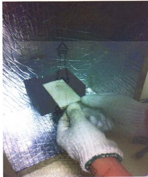
รูปที่ 4.6 การติดตั้งฉนวนเข้ากับแผ่นรองฉนวน
