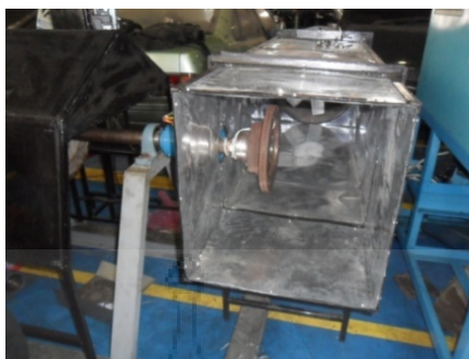
รูปที่ 3.27 ประกอบงานเบรกเข้ากับเพลาลมและอุโมงค์
