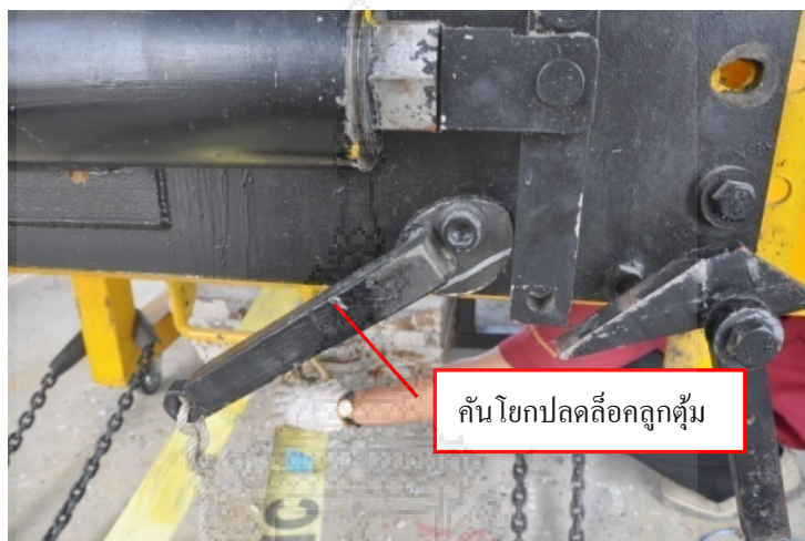
รูปที่ 3.28 การติดตั้งกลไกปลดล็อกลูกตุ้มน้ำหนัก
