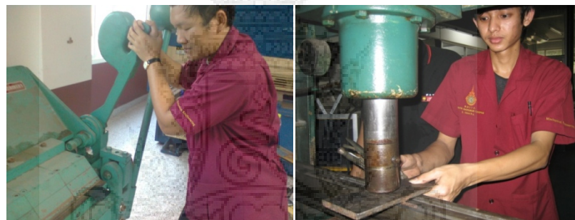
รูปที่ 3.11 การตัดและการอัดขึ้นรูปโครงสร้างกันแรงกระแทก
