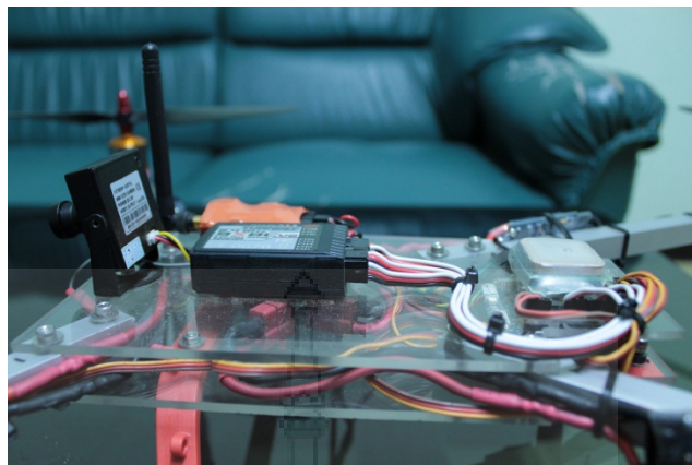
รูปที่ 3.19 รีซีฟต่อกับ Controller (Multi Wii Manual rev 1.00)
