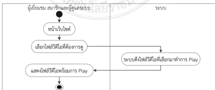
ภาพที่ 3-18 แผนภาพกิจกรรมการทำงานการดูไฟล์วีดีโอ
