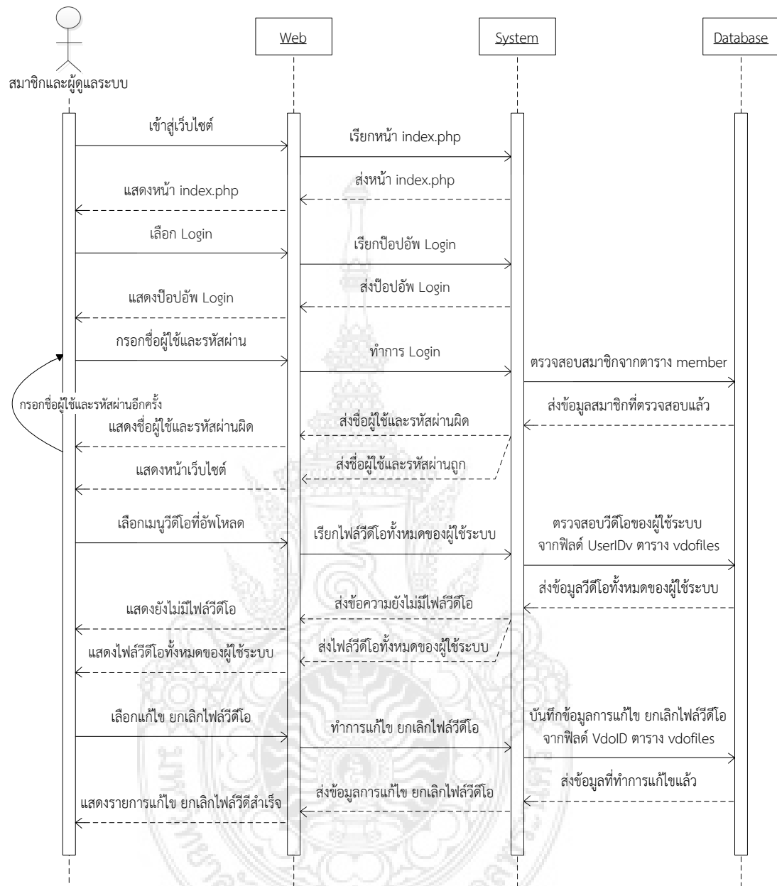
ภาพที่ 3-8 แผนภาพจำลองลำดับกระบวนการแก้ไขหรือยกเลิกไฟล์วิดีโอ
