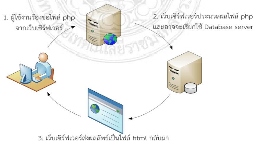
ภาพที่ 2-14 กลไกการทำงานของไฟล์พีเอชพี
