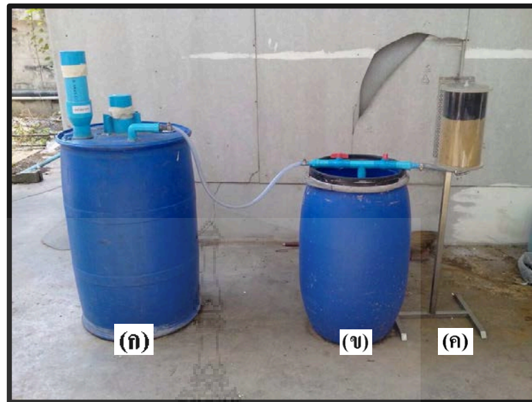
ภาพที่ 3.38 ลักษณะการต่ออุปกรณ์ของ (ก) ถังหมักก๊าซชีวภาพขนาด 200 ลิตร และ (ข) ถังเก็บก๊าซขนาด 120 ลิตร ต่อกับ (ค) เครื่องกรองก๊าซไฮโดรเจนซัลไฟด์ขนาดบรรจุ 2,500 กรัม ด้วยตัวกรองทรายและถ่านกัมมันต์
