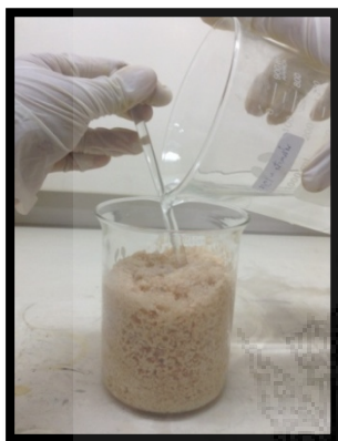
1. เท HCl เข้มข้นร้อยละ 4 ลงในเปลือกกุ้ง
