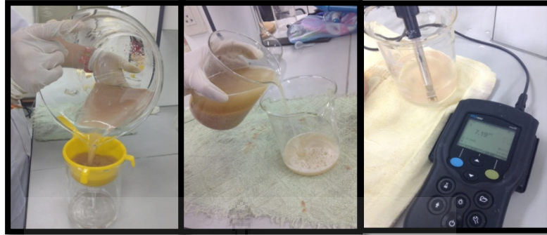
3. กรองและล้างน้ำกลั่นจนมีค่าพีเอชเป็นกลาง
