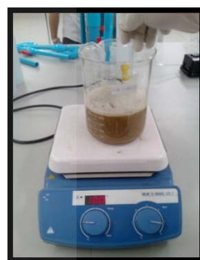
2. ต้มที่อุณหภูมิ 100 องศาเซลเซียส เป็นเวลา 2 ชั่วโมง
