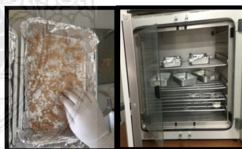
4. นำไปอบที่อุณหภูมิ 103 องศาเซลเซียส เป็นเวลา 2 ชั่วโมง
