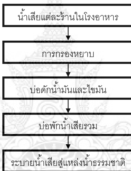
แผนภาพที่ 2-1 กระบวนการบำบัดน้ำเสียจากโรงอาหาร
