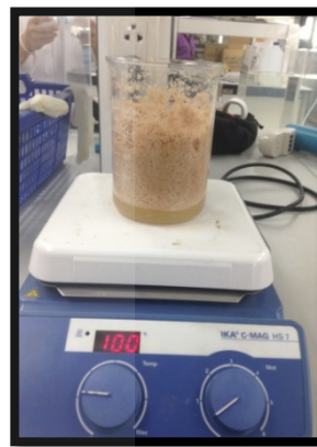
2. ต้มที่อุณหภูมิ 100 องศาเซลเซียส เป็นเวลา 2 ชั่วโมง
