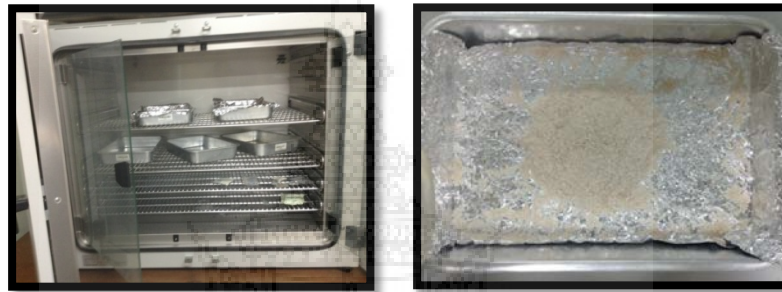
4. นำไปอบที่อุณหภูมิ 103 องศาเซลเซียส เป็นเวลา 2 ชั่วโมง
