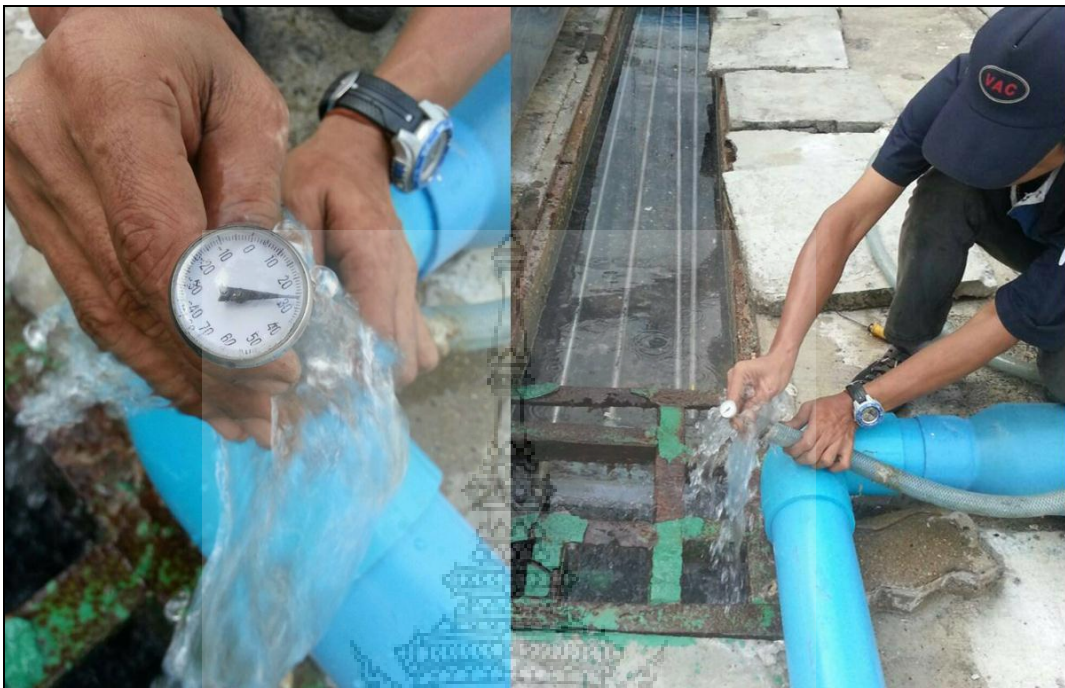
ภาพ 3.5 วัดอุณหภูมิน้ำดีก่อนต่อเข้าท่อทำการแลกเปลี่ยนความร้อน 29°C
