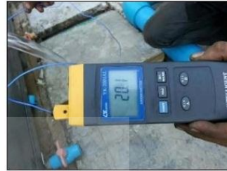
รูปที่ 6 วัดอุณหภูมิน้ำดื่มที่วัดได้หลังจากผ่านเครื่อง heat exchanger แล้ว 20.1°C
