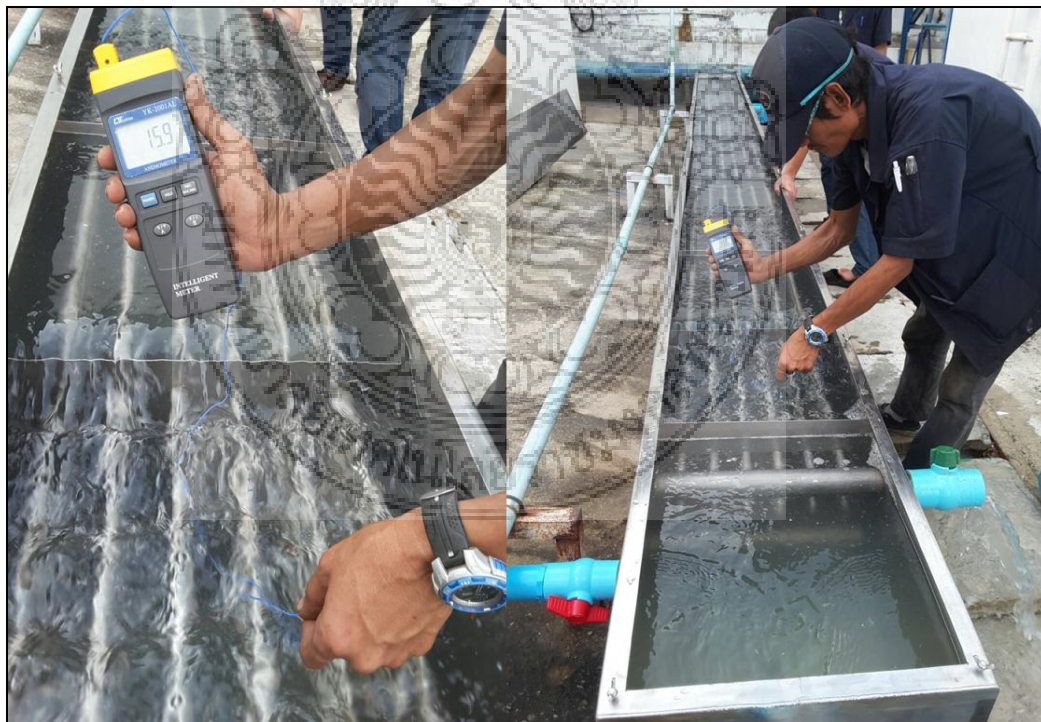
ภาพ 4.14 วัดอุณหภูมิน้ำเสียด้านขาออกเครื่องแลกเปลี่ยนความร้อน 15.9°C
