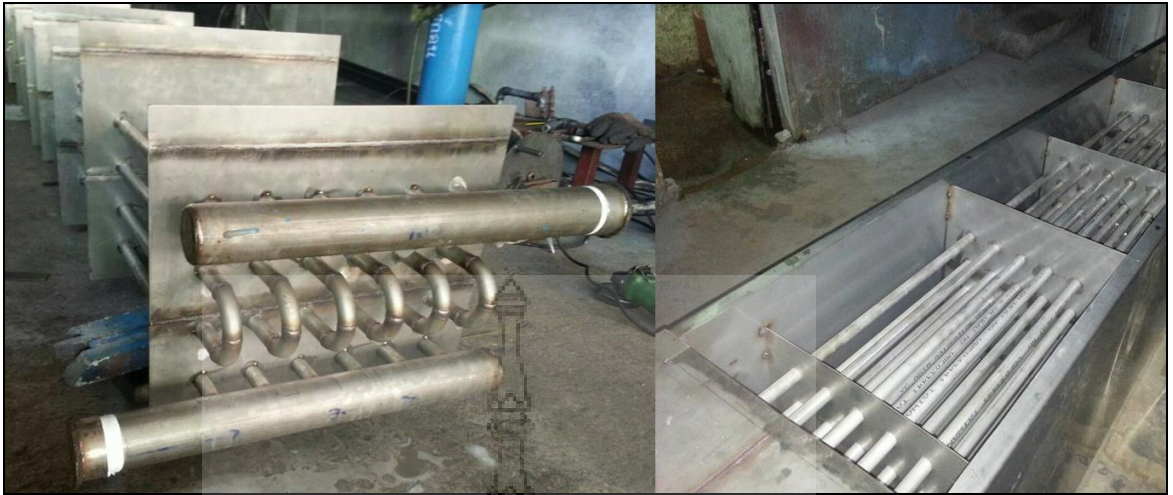
ภาพ 4.1 การเริ่มลงมือสร้างโดยเจาะแผ่นเพลทสำหรับเป็นรูร้อยท่อจำนวน 24 รู แล้วนำท่อสแตนเลสมาร้อยในแผ่นเพลท เพื่อทำการเชื่อมต่ออนุกรมกันจำนวน 4 เส้น 6 ชุด ด้านน้ำเข้าออกจะติดท่อ Header ไว้เพื่อรับน้ำแล้วจ่ายให้ท่อแต่ละชุด
