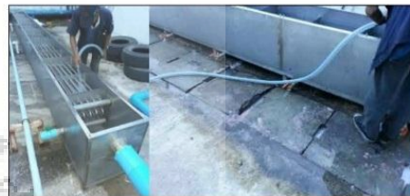
รูปที่ 7 ขั้นตอนการล้างทำความสะอาดฝาปิดสะดวก สามารถให้พนักงานล้างทำความสะอาดได้ง่าย
