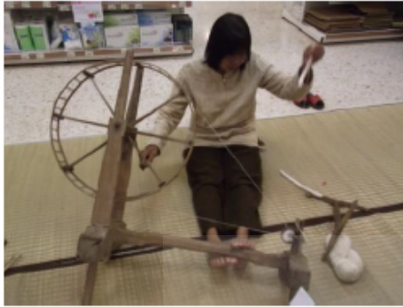
ภาพที่ ๒.๑๐ การตีเกลียวด้วยเครื่องมือ “กระหัด” ที่มา : www.bansuanporpeang.com
