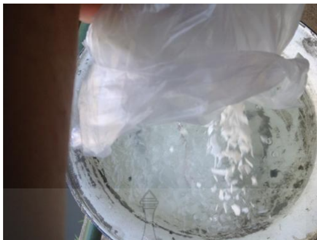
รูปที่ 3.13 การเตรียมสารละลายโซเดียมไฮดรอกไซด์ (NaOH) ความเข้มข้น ร้อยละ 12
