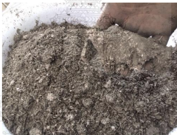
รูปที่ 3.16 ส่วนผสมที่พร้อมสำหรับขึ้นรูปแผ่นใยอัดซีเมนต์
