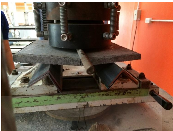
รูปที่ 3.23 การทดสอบความต้านทานแรงอัดและมอดุลัสยืดหยุ่นของแผ่นใยอัดซีเมนต์จาก ต้นผักตบชวาด้วยเครื่องทดสอบอเนกประสงค์ (UTM)
