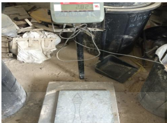
รูปที่ 3.20 การชั่งน้ำหนักแผ่นใยอัดซีเมนต์ผสมเส้นใยต้นผักตบชวา
