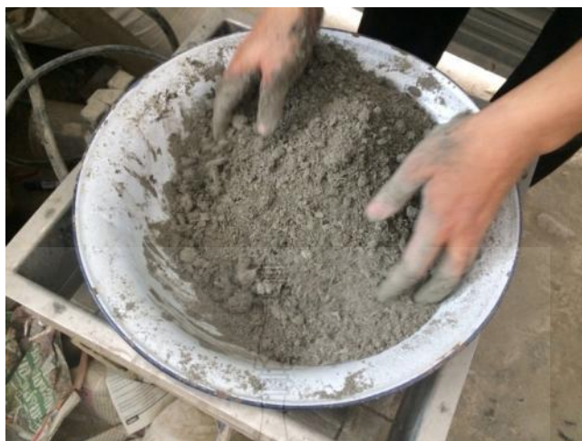
รูปที่ 3.15 การผสมส่วนผสมสำหรับขึ้นรูปแผ่นใยอัดซีเมนต์ลงในอ่างผสม
