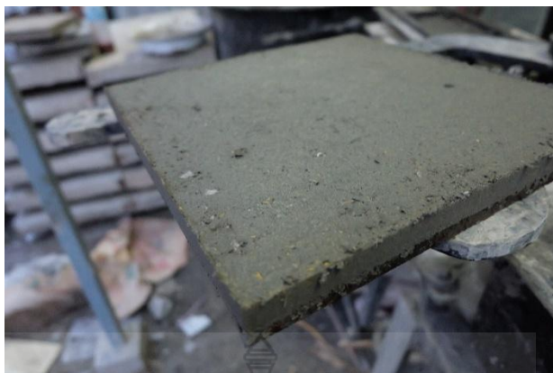
รูปที่ 3.18 แผ่นใยอัดซีเมนต์จากเส้นใยต้นผักตบชวา
