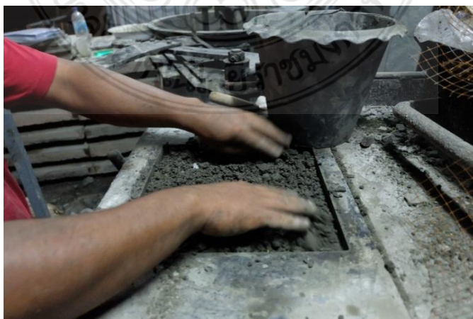
รูปที่ 3.17 การเทส่วนผสมลงในเครื่องอัดแผ่นอัดซีเมนต์
