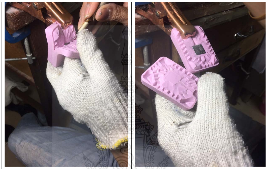
รูปที่ 3.11 แสดงลักษณะการผ่าพิมพ์ยางสำหรับทำชิ้นงานทดสอบ
