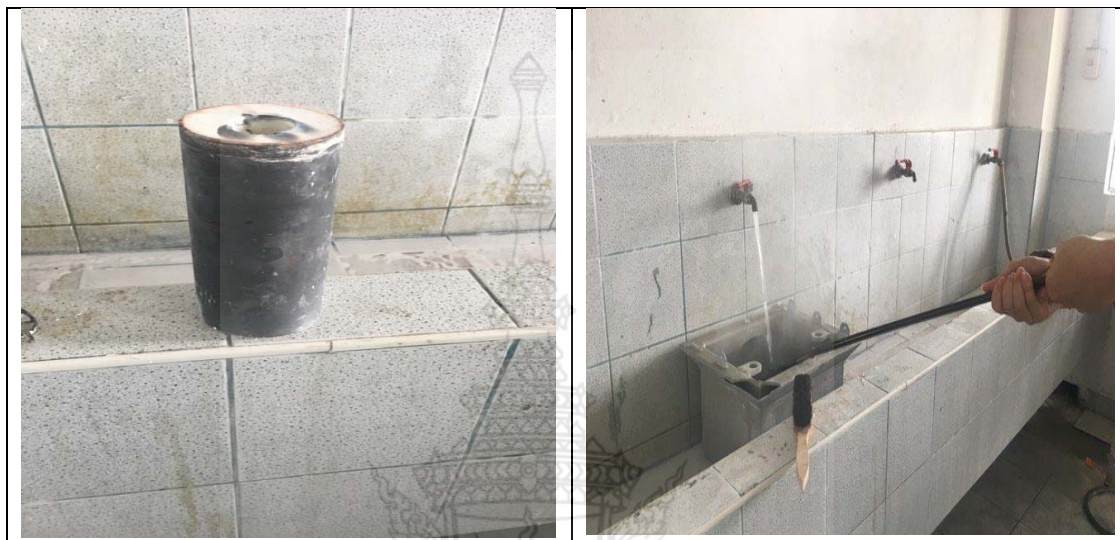
รูปที่ 3.17 การล้างกระบอกละหลังการหล่อ
