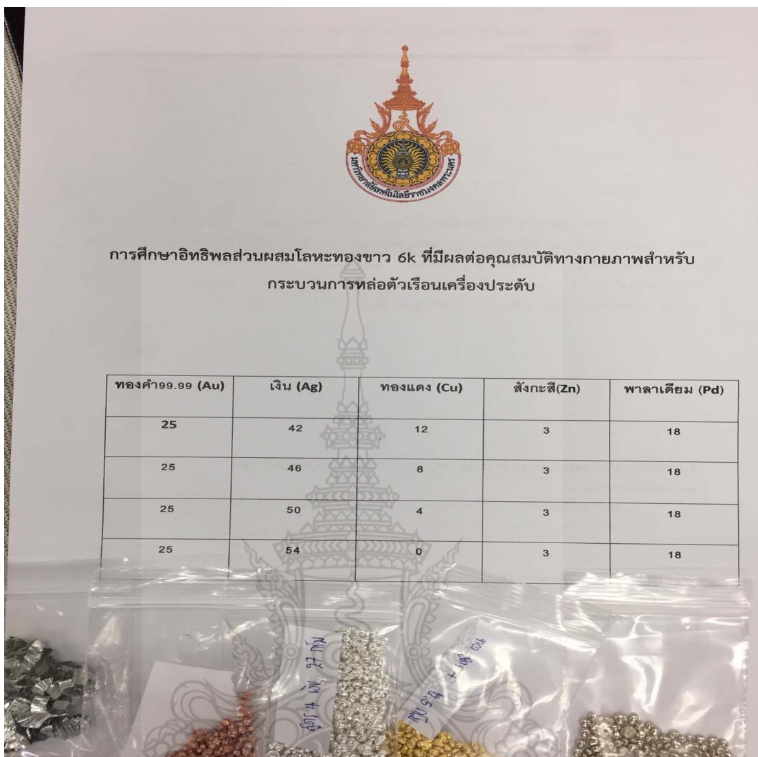
รูปที่ 3.7 แสดงอัตราส่วนผสมต่างๆ ของชิ้นงานทดสอบโลหะทองขาว 6K
