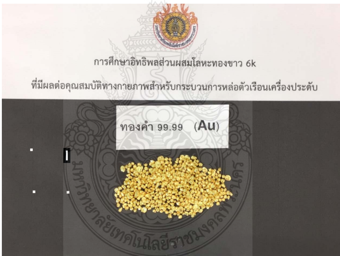
รูปที่ 3.2 แสดงลักษณะโลหะทองคำที่ใช้การทดลอง
