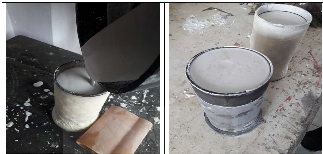
รูปที่ 3.14 แสดงการเทปูนลงในแบบพิมพ์
