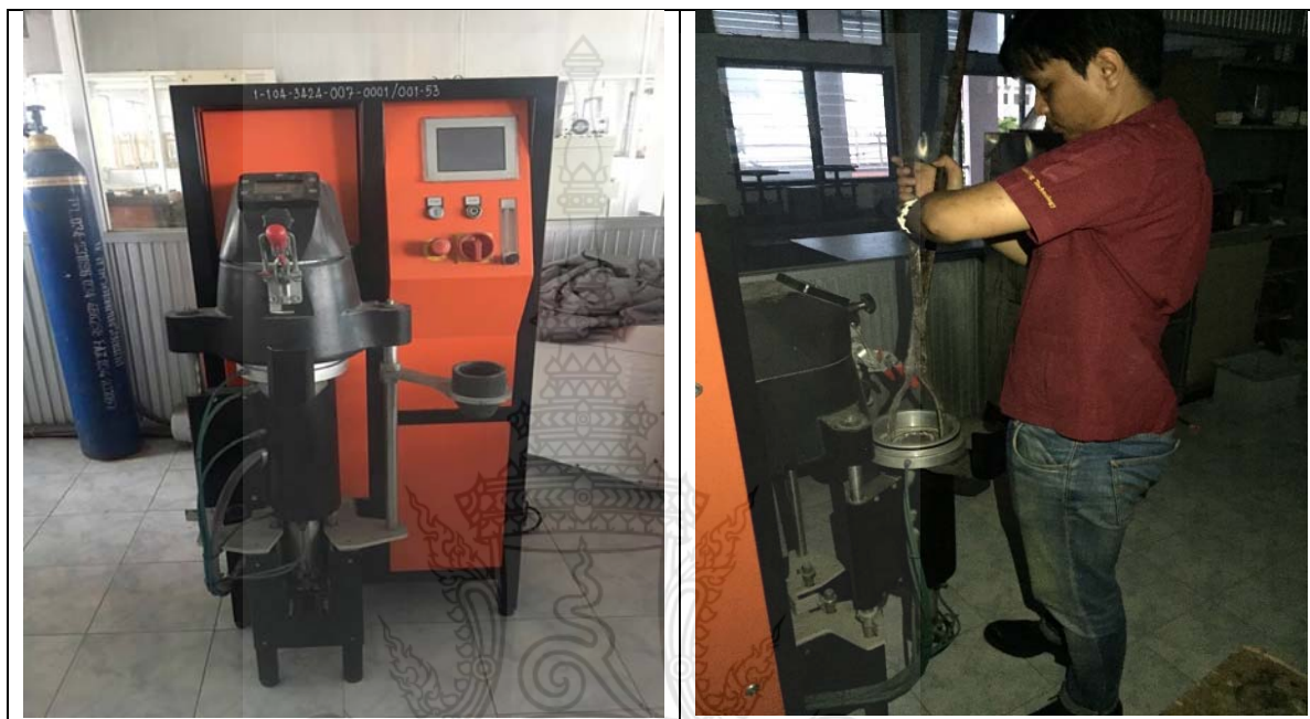
รูปที่ 3.16 แสดงขั้นตอนการหล่อชิ้นงานทดสอบ
