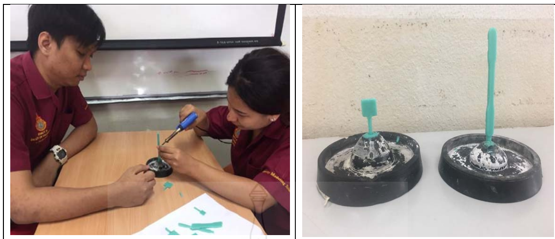
รูปที่ 3.13 แสดงการติดต้นเทียนสำหรับทำชิ้นงานทดสอบ
