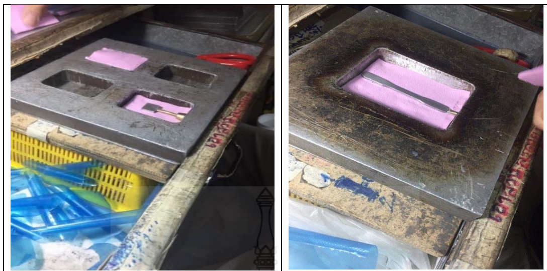
รูปที่ 3.9 แสดงการวางชิ้นงานลงบล็อกอัดพิมพ์ยาง
