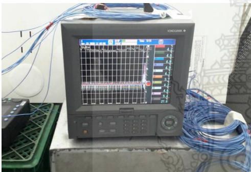
ก. เครื่องวัดและบันทึกอุณหภูมิ 30 ช่อง
