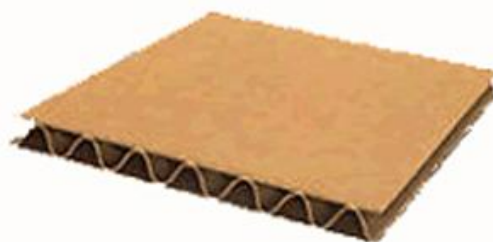
ภาพที่ 2.7 แสดงลักษณะของกระดาษลูกฟูก Single Wall
