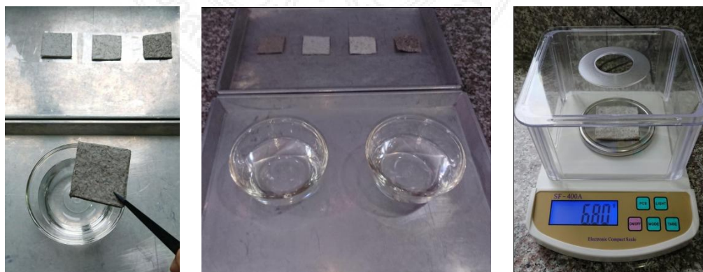
ภาพที่ 3.3 ภาพการทดสอบการดูดซึมของเหลวและการชั่งน้ำหนักหลังการดูดซึม
