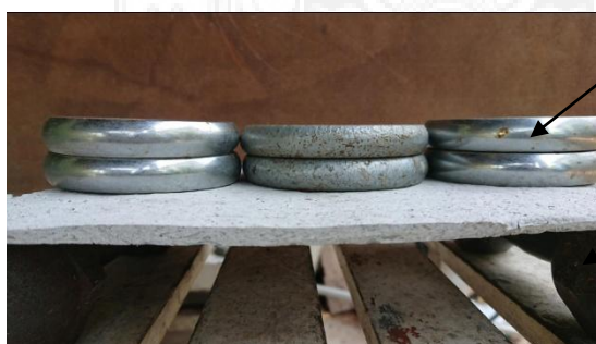
ภาพที่ 3.2 แสดงการทดสอบการรับน้ำหนักของแผ่นกระดาษด้วยกลวิธีเปเปอร์มาเช่
