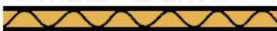
ภาพที่ 2.3 แสดงโครงสร้างของกระดาษชนิดลอน B
