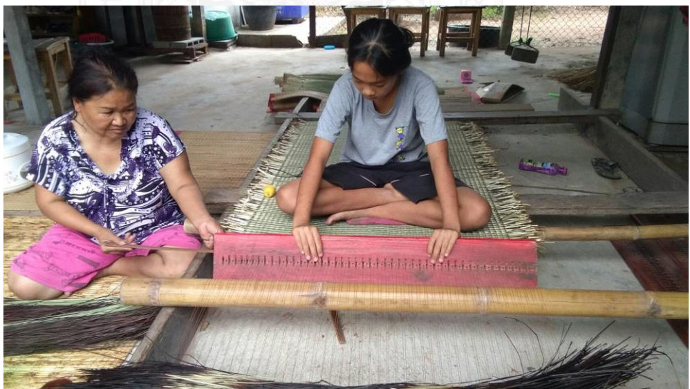
รูปที่ 6.2 เส้นกกที่แห้งนำมาข้อมสี ตากแดดให้แห้งและการทอมือ ภาษาอีสานเรียก กางโอง ที่มา: คมเขต เพ็ชรรัตน์ และคณะ. 2561
