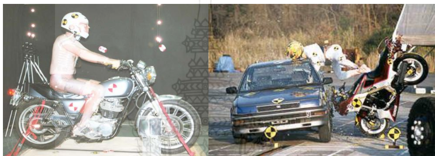
รูปที่ 1.3 หุ่นทดสอบการชนของจักรยานยนต์ [10-11]
