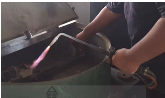
รูปที่ 3.18 หลอมทองเหลืองในเครื่องหล่อเหวี่ยง
