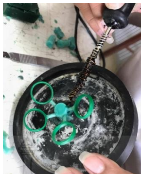
รูปที่ 3.15 ชิ้นงานที่ติดทางเดินน้ำโลหะและต้นเทียน นำชิ้นงานที่แว็กซ์ที่ติดทางเดินน้ำโลหะแล้วเชื่อมติดเข้ากับต้นเทียนและฐานยาง โดยใช้ความร้อนจากหัวแร้งให้WAXละลายและเชื่อมเข้าด้วยกัน
