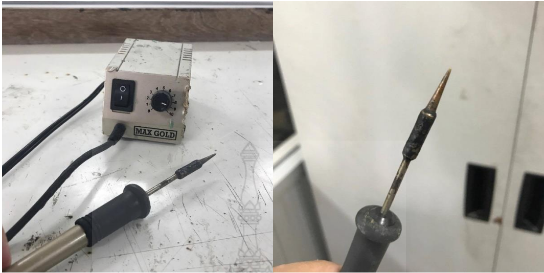
รูปที่ 3.3 หัวแร้งพร้อมหม้อแปลงปรับแรงดันกระแสไฟฟ้า
