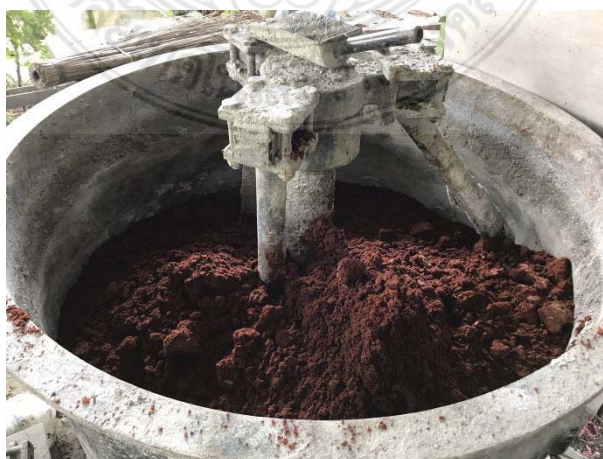
รูปที่ 3.29 การผสมดินเหนียวด้วยเครื่องผสม
