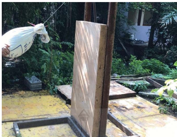
รูปที่ 3.62 การวัดความสูงของวัสดุぬ่มขนาดใหญ่ที่ใช้กระแทกลงบนของ ผนังบ้านดินสำเร็จรูปขนาด 60x120x15 เซนติเมตร
