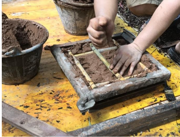
รูปที่ 36 การนำส่วนผสมไปอัดขึ้นรูปในแบบหล่อ พร้อมทั้งเสริมไม้รวก
