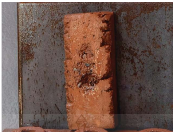
รูปที่ 3.53 ผนังบ้านดินสำเร็จรูปขนาด 40x20x10 เซนติเมตร ที่วิบัติจากการทดสอบความชะล้าง
