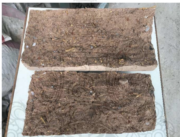
รูปที่ 3.56 ตัวอย่างลักษณะเนื้อผนังบ้านดินสำเร็จรูปทรงกระบอก ขนาดเส้นผ่านศูนย์กลาง 15 เซนติเมตร สูง 30 เซนติเมตร ที่วิบัติจากการทดสอบความต้านทานแรงอัด
