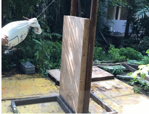
รูปที่ 58 การวัดความสูงของวัสดุถมขนาดใหญ่ที่ใช้กระแทกลงบนของ ผนังบ้านดินสำเร็จรูปขนาด 60x120x15 เซนติเมตร
