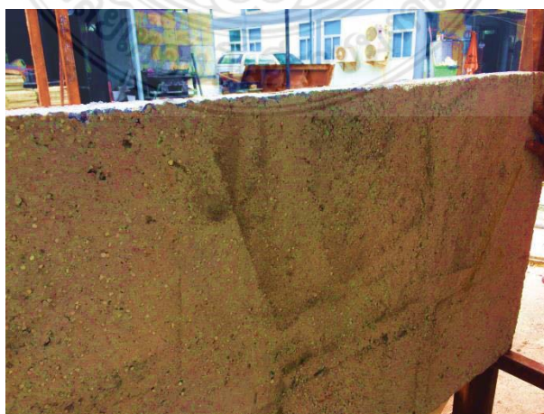
รูปที่ 3.64 ลักษณะการวางผนังบ้านดินสำเร็จรูปขนาด 60x120x15 เซนติเมตร สำหรับทดสอบความตรง
