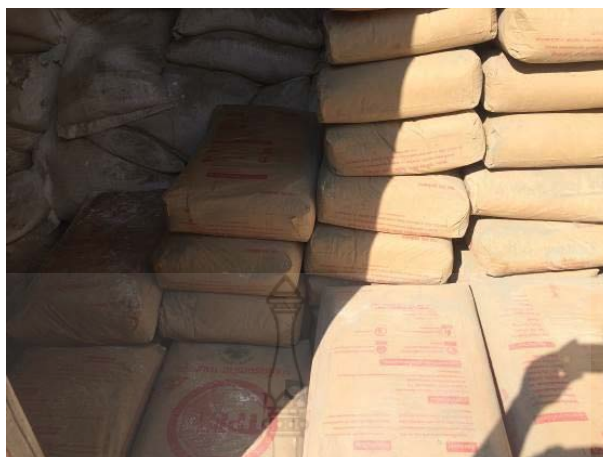
รูปที่ 3.3 ปูนซีเมนต์พอร์ตแลนด์ประเภทที่ 1
