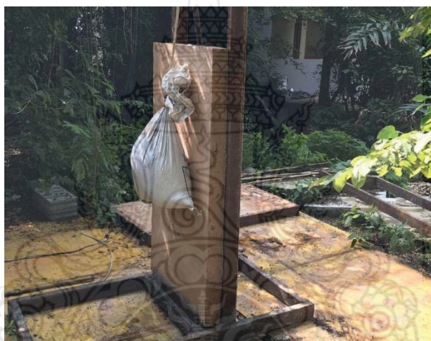
รูปที่ 3.63 ผลการกระแทกของวัสดุぬ่มขนาดใหญ่บนผนังบ้านดินสำเร็จรูปขนาด 60x120x15 เซนติเมตร
