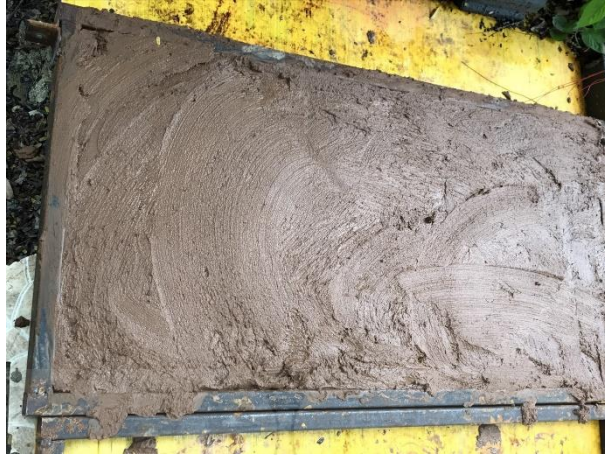
รูปที่ 3.42 ตัวอย่างผนังบ้านดินสำเร็จรูปขนาด 60x120x15 เซนติเมตร
