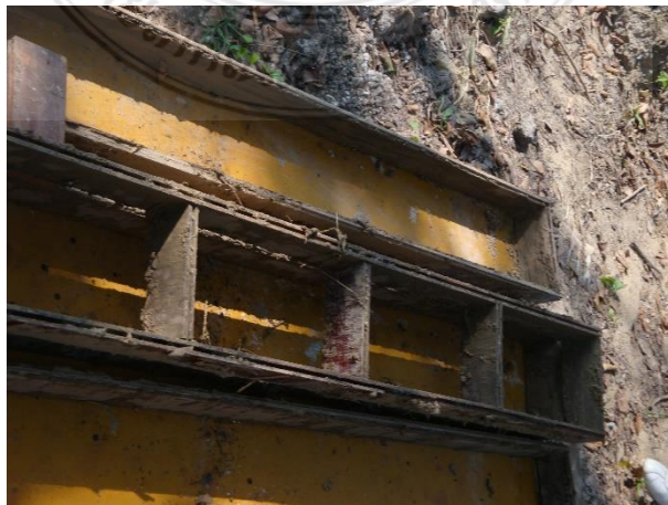
รูปที่ 11 แบบหล่อนขนาด 40 x 20 x 10 เซนติเมตร
