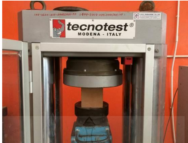
รูปที่ 16 การทดสอบความต้านทานแรงอัดของก้อนดินซีเมนต์เพื่อหาอัตราส่วนที่เหมาะสม
