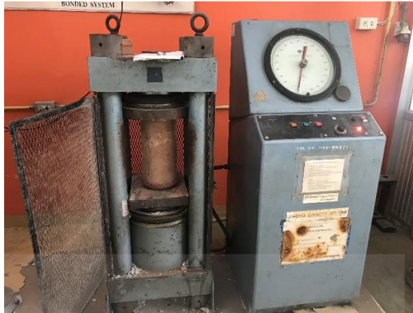
รูปที่ 50 การทดสอบความต้านทานแรงอัดของตัวอย่างผนังบ้านดินสำเร็จรูปทรงกระบอก ขนาดเส้นผ่านศูนย์กลาง 15 เซนติเมตร สูง 30 เซนติเมตร
