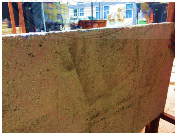
รูปที่ 60 ลักษณะการวางผนังบ้านดินสำเร็จรูปขนาด 60x120x15 เซนติเมตร สำหรับทดสอบความตรง
