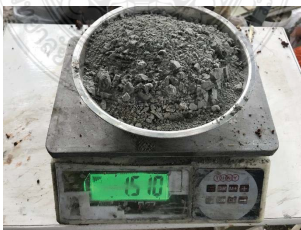
รูปที่ 3.23 การชั่งน้ำหนักปูนซีเมนต์
