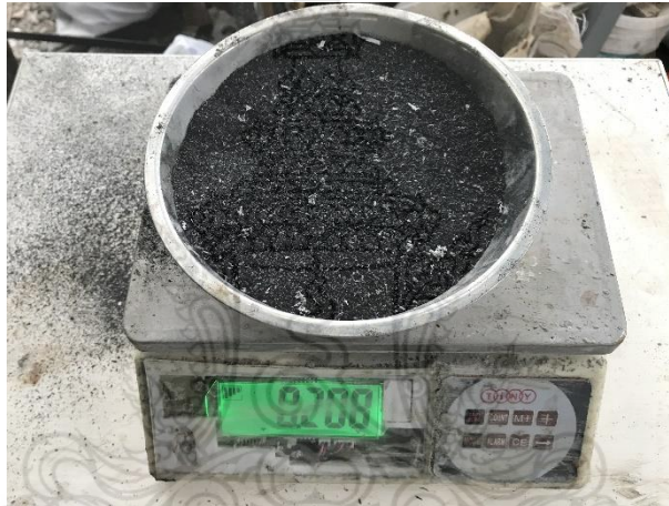
รูปที่ 20 การชั่งน้ำหนักเถ้าแกลบ
