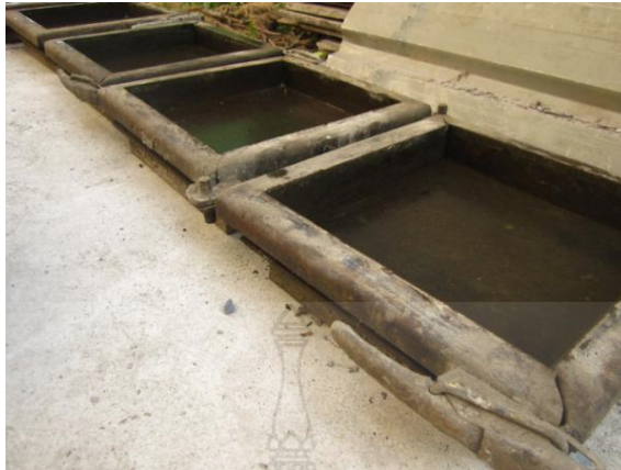
รูปที่ 12 แบบหล่อขนาด 30 x 30 x 5 เซนติเมตร
