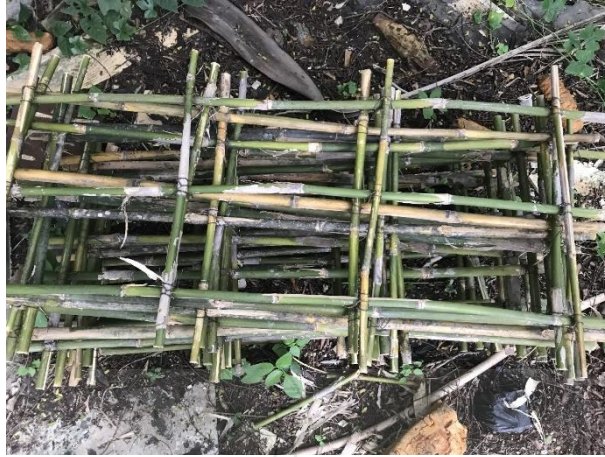
รูปที่ 9 ไม้รวกสำหรับเสริมในตัวอย่างผนังขนาดใหญ่
