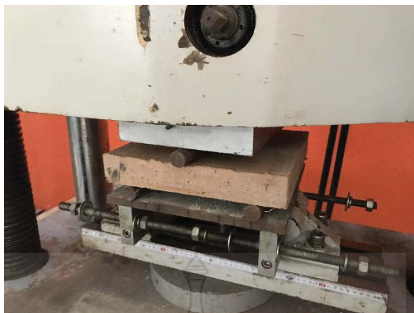
รูปที่ 3.57 การทดสอบความต้านทานแรงดัดของตัวอย่างผนังบ้านดินสำเร็จรูป ขนาด 30x30x10 เซนติเมตร
