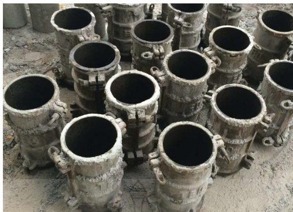
รูปที่ 3.14 แบบหล่อทรงกระบอก ขนาดเส้นผ่านศูนย์กลาง 15 เซนติเมตร สูง 30 เซนติเมตร
