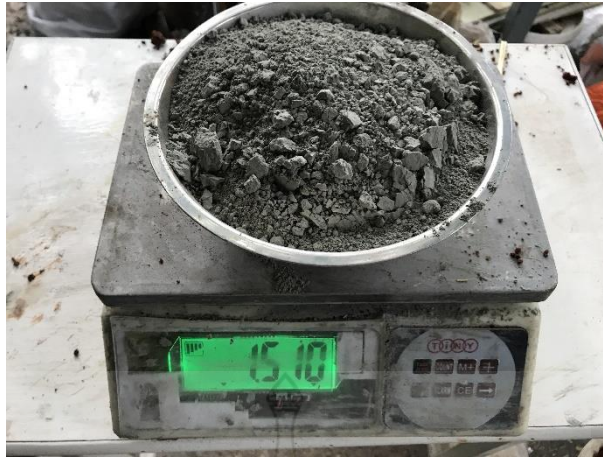
รูปที่ 19 การชั่งน้ำหนักปูนซีเมนต์
