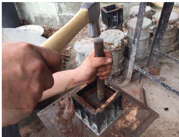
รูปที่ 3.18 การอัดส่วนผสมลงในแบบหล่อเพื่อขึ้นรูปก้อนดินซีเมนต์
