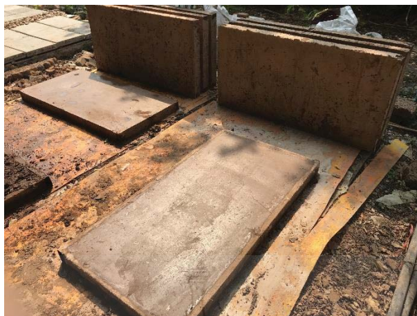
รูปที่ 3.47 ตัวอย่างผนังบ้านดินสำเร็จรูปผสมน้ำยางพารา ขนาด 60x120x15 เซนติเมตร สำหรับการทดสอบ
