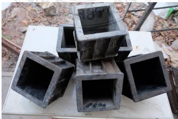
รูปที่ 14 แบบหล่อขนาด 10x10x10 เซนติเมตร
