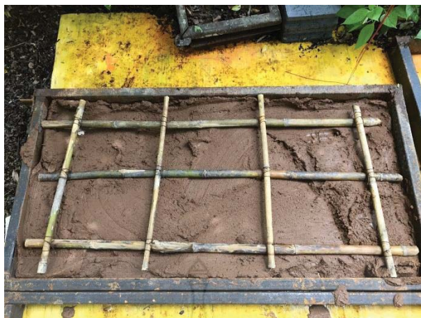
รูปที่ 3.44 การเสริมไม้รวกลงในตัวอย่างผนังบ้านดินสำเร็จในแบบหล่อขนาด 60x120x15 เซนติเมตร
