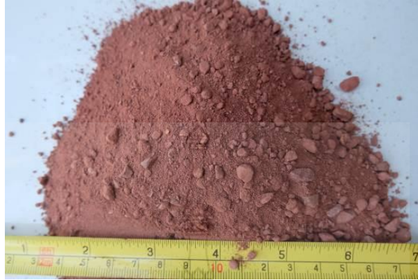
รูปที่ 2 ดินเหนียวแห้งสำหรับการขึ้นรูปแผ่นผนังดินสำเร็จรูป
