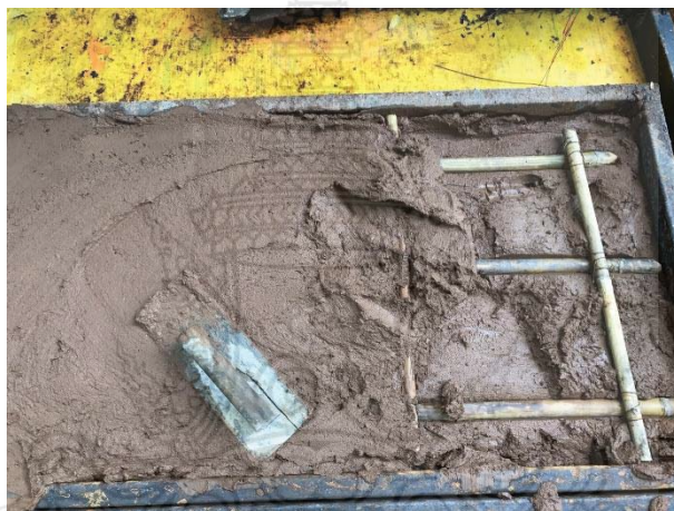
รูปที่ 3.45 การฉาบตัวอย่างผนังบ้านดินสำเร็จในแบบหล่อขนาด 60x120x15 เซนติเมตร เพื่อหุ้มไม้รวก
