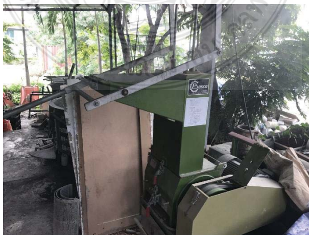
รูปที่ 3.16 เครื่องบดเส้นใย
