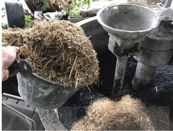
รูปที่ 28 การเทฟางข้าวลงในเครื่องผสม
