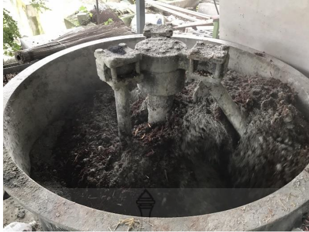
รูปที่ 31 การผสมส่วนผสมให้เข้ากันด้วยเครื่องผสมก่อนเติมน้ำประปา
