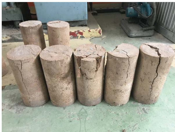
รูปที่ 3.55 ตัวอย่างผนังบ้านดินสำเร็จรูปทรงกระบอก ขนาดเส้นผ่านศูนย์กลาง 15 เซนติเมตร สูง 30 เซนติเมตร ที่วิบัติจากการทดสอบความต้านทานแรงอัด
