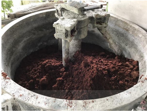
รูปที่ 25 การผสมดินเหนียวด้วยเครื่องผสม
