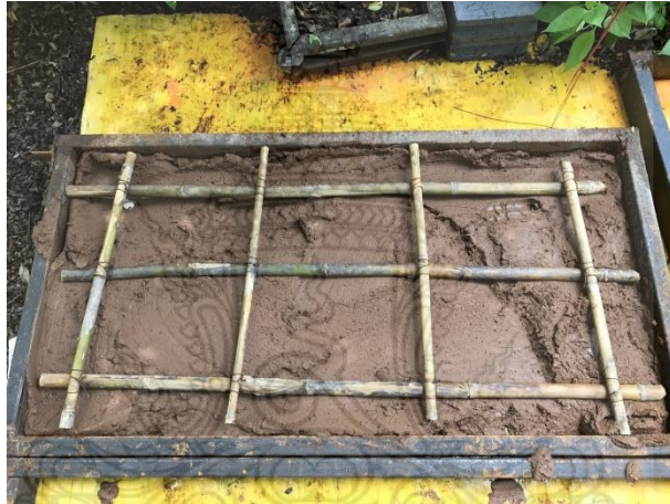
รูปที่ 40 การเสริมไม้รวกลงในตัวอย่างผนังบ้านดินสำเร็จในแบบหล่อขนาด 60x120x15 เซนติเมตร
