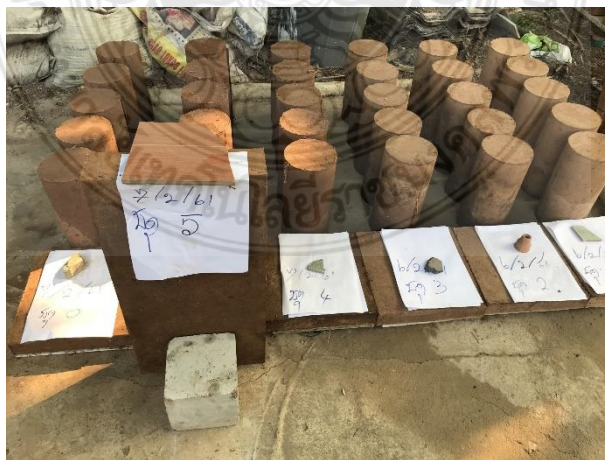
รูปที่ 44 ก่อนตัวอย่างผนังบ้านดินสำเร็จรูปผสมน้ำยางพาราขนาดต่างๆ สำหรับการทดสอบ
