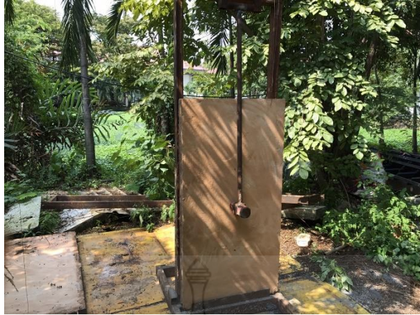
รูปที่ 55 การเตรียมผนังบ้านดินสำเร็จรูปขนาด 60x120x15 เซนติเมตร สำหรับทดสอบความทนการกระแทก
