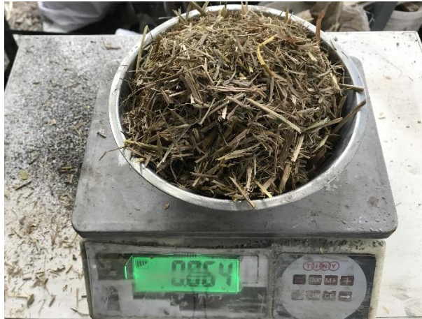
รูปที่ 22 การชั่งน้ำหนักฟางที่ย่อยขนาดแล้ว
