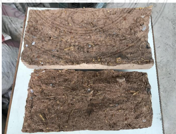
รูปที่ 52 ตัวอย่างลักษณะเนื้อผนังบ้านดินสำเร็จรูปทรงกระบอก ขนาดเส้นผ่านศูนย์กลาง 15 เซนติเมตร สูง 30 เซนติเมตร ที่วิบัติจากการทดสอบความต้านทานแรงอัด
