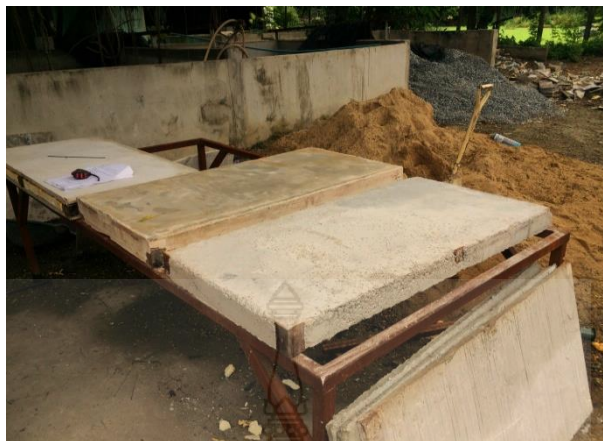
รูปที่ 61 การวางผนังบ้านดินสำเร็จรูปขนาด 60x120x15 เซนติเมตรเพื่อทดสอบความแข็ง
