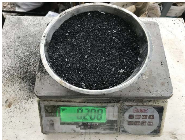
รูปที่ 3.24 การชั่งน้ำหนักถ้ำกลบ
