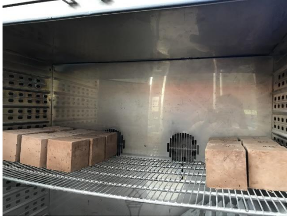
รูปที่ 47 การอบตัวอย่างผนังบ้านดินสำเร็จรูปขนาด 10x10x10 เซนติเมตร ในตู้อบ สำหรับทดสอบการดูดซึมน้ำ
