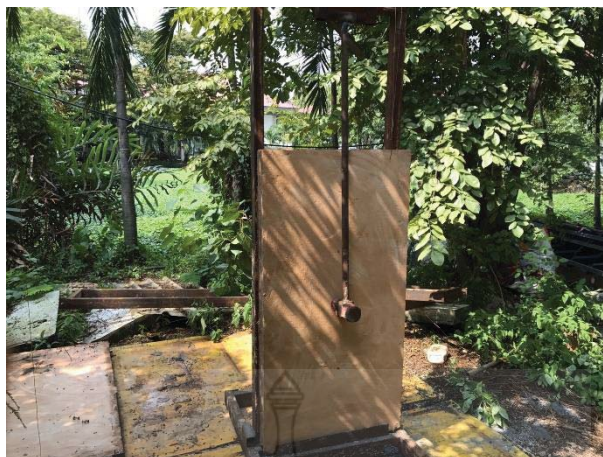
รูปที่ 3.59 การเตรียมผนังบ้านดินสำเร็จรูปขนาด 60x120x15 เซนติเมตร สำหรับทดสอบความทนการกระแทก
