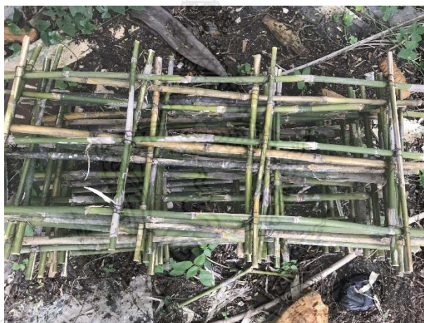
รูปที่ 3.10 ไม้รวกสำหรับเสริมในตัวอย่างผนังขนาดใหญ่
