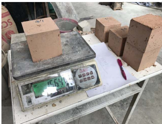
รูปที่ 3.49 การชั่งน้ำหนักตัวอย่างผนังบ้านดินสำเร็จรูปขนาด 10x10x10 เซนติเมตร สำหรับทดสอบความหนาแน่น
