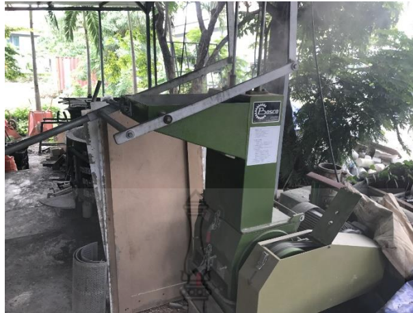
รูปที่ 15 เครื่องบดเส้นใย
