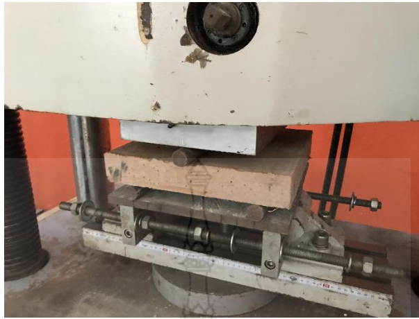
รูปที่ 53 การทดสอบความต้านทานแรงดัดของตัวอย่างผนังบ้านดินสำเร็จรูป ขนาด 30x30x10 เซนติเมตร
