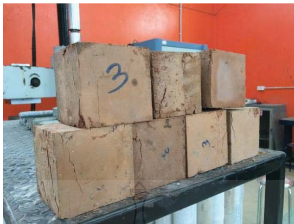
รูปที่ 3.21 ก้อนดินซีเมนต์ที่วิบัติจากการทดสอบความต้านทานแรงอัด
