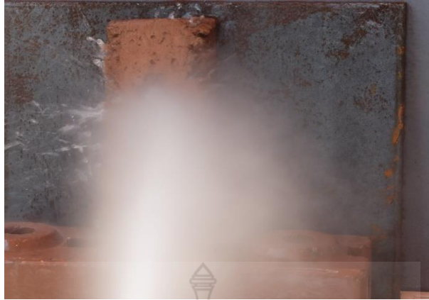
รูปที่ 48 การฉีดน้ำแรงดันสูงใส่ผนังบ้านดินสำเร็จรูปขนาด 40x20x10 เซนติเมตร สำหรับทดสอบความชะล้าง
