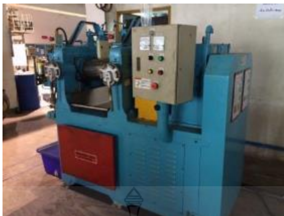
รูปที่ 3.11 เครื่องบดผสมยางแบบสองลูกกลิ้ง
