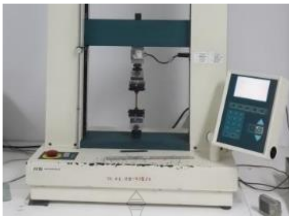
รูปที่ 3.43 การทดสอบความต้านทานแรงดึงของกระเบื้องยางธรรมชาติผสมพลาสติกอีวีเอ ที่มีคุณสมบัติหน่วงไฟ
