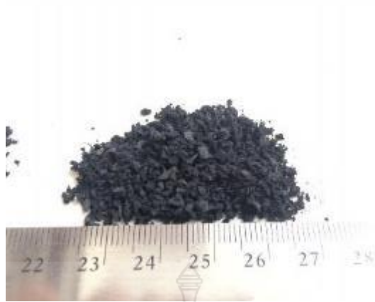
รูปที่ 11 พลาสติกอีวีเอหลังการบดย่อย ขนาดผ่านตะแกรงเบอร์ 10 หรือ 2 มิลลิเมตร
