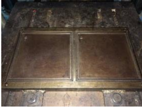
รูปที่ 13 แบบหล่อแผ่นกระเบื้องยาง
