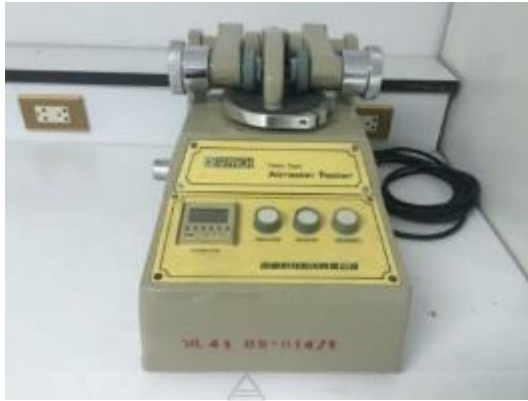
รูปที่ 20 เครื่องทดสอบความสึกหรอของยาง
