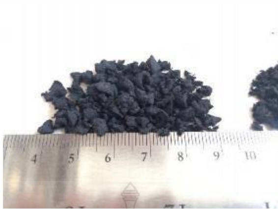
รูปที่ 8 พลาสติกอีวีเอหลังการบดย่อย ขนาดผ่านตะแกรงเบอร์ 4 หรือ 4.75 มิลลิเมตร
