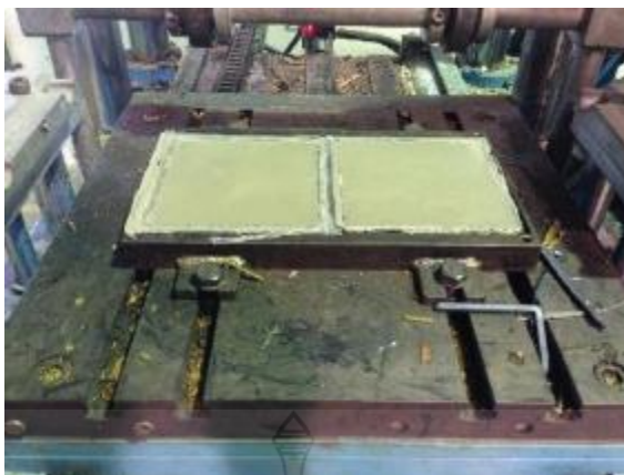
รูปที่ 3.35 การนำแผ่นกระเบื้องยางธรรมชาติผสมพลาสติกอีวีเอที่มีคุณสมบัติทนวงไฟออกจากแบบหล่อ
