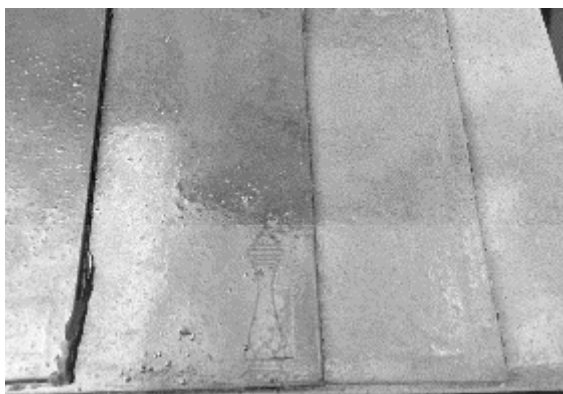
รูปที่ 3.20 พื้นผิวของแผ่นกระเบื้องยางธรรมชาติผสมพลาสติกอีวีเอขนาดผ่านตะแกรงเบอร์ 4 (EVA#4) (แผ่นที่ 1 จากด้านซ้าย) ผ่านตะแกรงเบอร์ 6 (EVA#6) (แผ่นที่ 2 จากด้านซ้าย) ผ่านตะแกรงเบอร์ 8 (EVA#8) (แผ่นที่ 3 จากด้านซ้าย) และผ่านตะแกรงเบอร์ 10 (EVA#10) (แผ่นที่ 4 จากด้านซ้าย)
