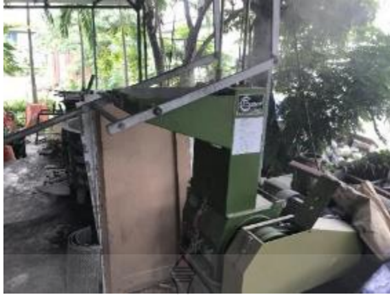
รูปที่ 5 เครื่องบดเศษพลาสติกอีวีเอให้มีขนาดเล็ก
