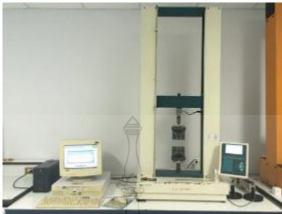
รูปที่ 18 เครื่องทดสอบอเนกประสงค์
