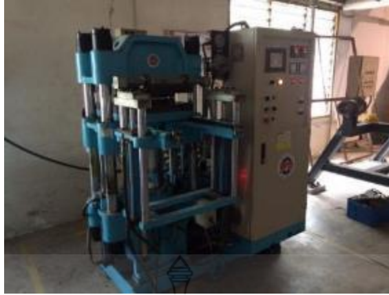
รูปที่ 15 เครื่องอัดขึ้นรูปด้วยความร้อน
