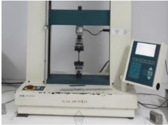
รูปที่ 46 การทดสอบความต้านทานแรงดึงของกระเบื้องยางธรรมชาติผสมพลาสติกอีวีเอ ที่มีคุณสมบัติห่วงไฟ
