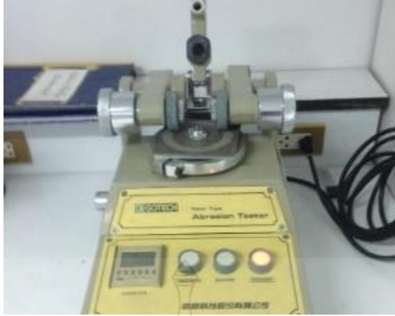
รูปที่ 49 การทดสอบการสึกหรอของแผ่นกระเบื้องยางธรรมชาติผสมพลาสติกอีวีเอ ที่มีคุณสมบัติทนวงไฟ
