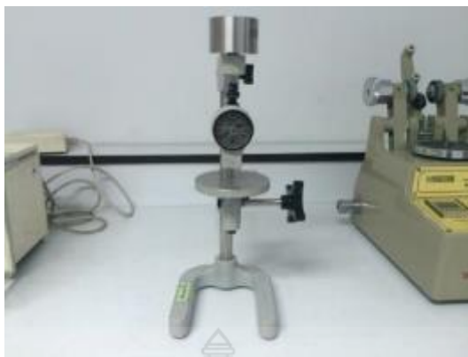
รูปที่ 3.16 เครื่องวัดความแข็งแบบชอร์เอ
