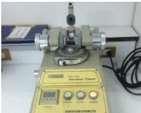
รูปที่ 3.46 การทดสอบการสึกหรอของแผ่นกระเบื้องยางธรรมชาติผสมพลาสติกอีวีเอ ที่มีคุณสมบัติทนไฟ
