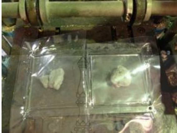
รูปที่ 34 การนำส่วนผสมใส่ลงในแบบหล่อที่รองด้วยแผ่นพลาสติก สำหรับป้องกันการติดแบบของส่วนผสม
