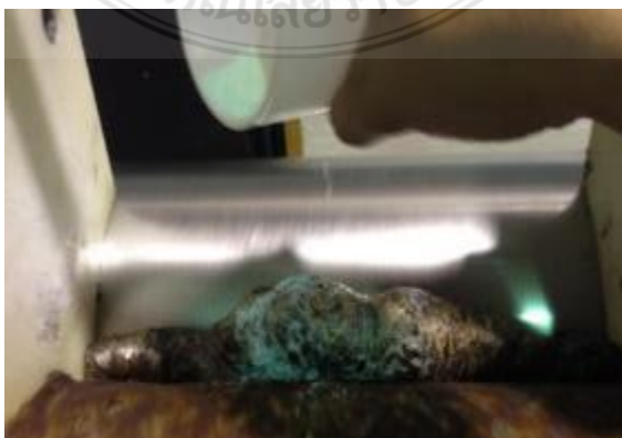
รูปที่ 3.24 การผสมสารซิงค์ออกไซด์ลงในยางธรรมชาติ
