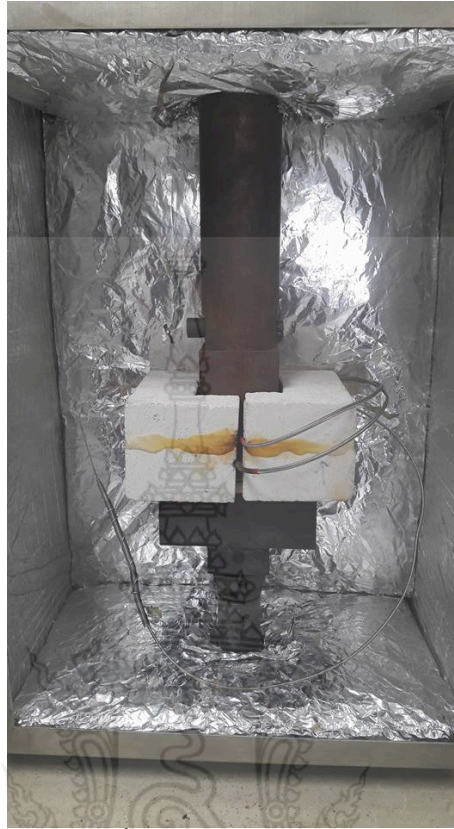
รูปที่ 3.19 การติดตั้งผ้าเบรกพร้อมฉนวนป้องกันความร้อน
