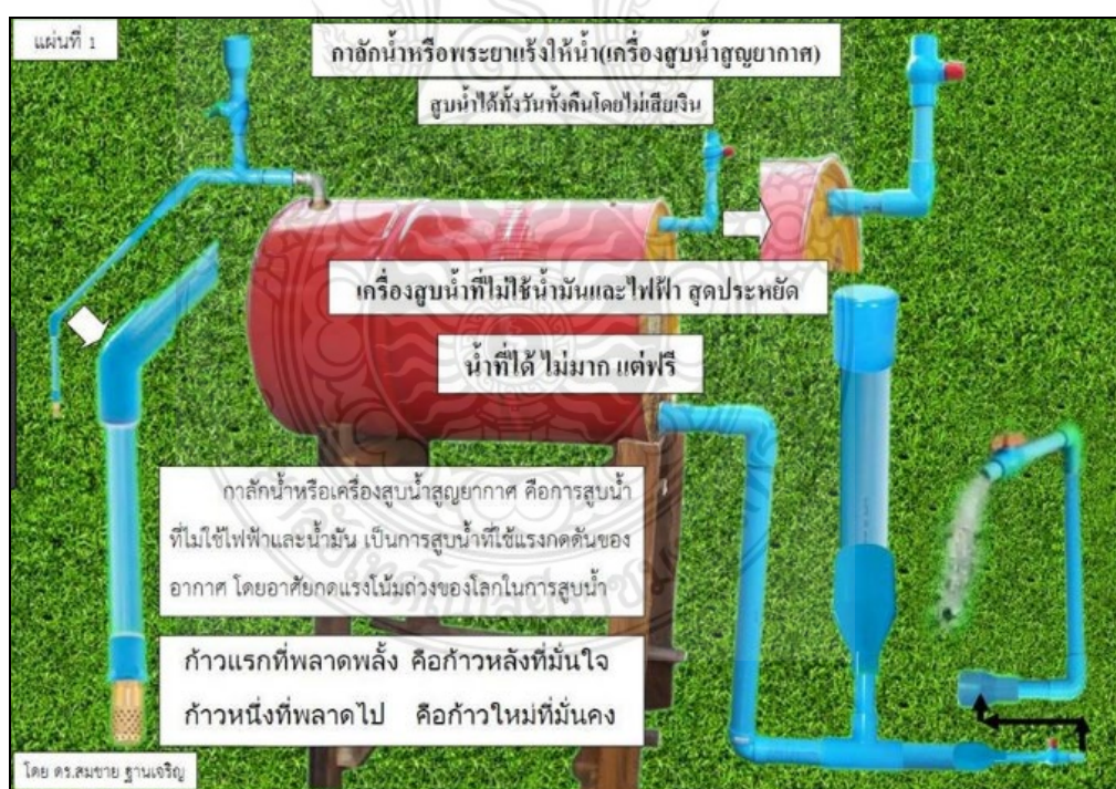
รูปที่ 3-4 อธิบายส่วนประกอบของกักน้ำสูญญากาศ
