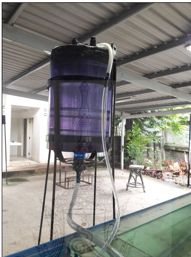
รูปที่ 3-7 อุปกรณ์กาลักน้ำสุญญากาศที่สร้างขึ้นจากถังน้ำดื่ม 20 ลิตร
