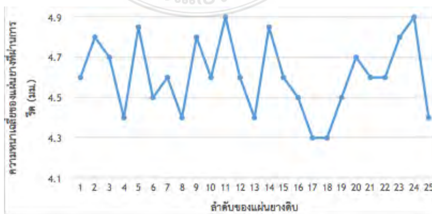
รูปที่ 4.18 กราฟแสดงความหนาของก๊อนยางดิบก่อนรืด
