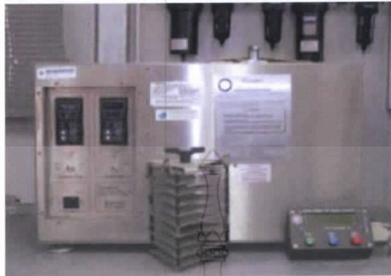
รูปที่ 3-7 เครื่องทดสอบ Pressure Aging Vessel Test
