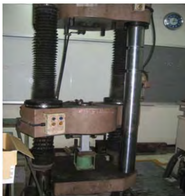
รูปที่ 1.4 การทดสอบแบบสถิต
