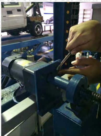
รูปที่ 3.14 การติดตั้งเซอร์โวมอเตอร์(Servo motor) และสกรูส่งกำลัง(Ball screw)
