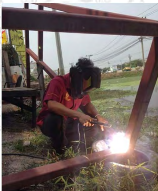
รูปที่ 3.12 การเชื่อมโครงสร้างเครื่องจำลองการชน
