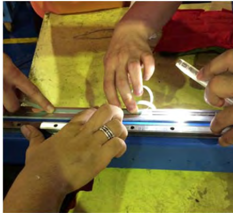
รูปที่ 3.17 การติดตั้งตัวระบุตำแหน่ง (Encoder)
