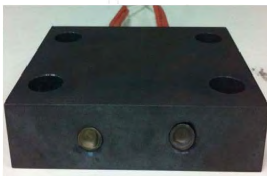
รูปที่ 3.5 แผ่นรองรับชิ้นงานชนิดดิสก์เบรก
