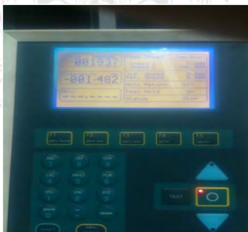
รูปที่ 3.20 การกำหนดแรงกดที่กระทำต่อผ้าเบรก
