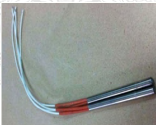
รูปที่ 3.6 ชุดให้ความร้อน (Heater)
