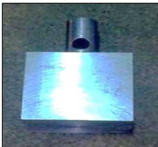
รูปที่ 3.9 หัวกดชิ้นงานทดสอบ(ดิกส์เบรก)
