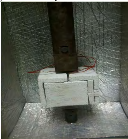
รูปที่ 3.19 การติดตั้งผ้าเบรกพร้อมฉนวนป้องกันความร้อน
