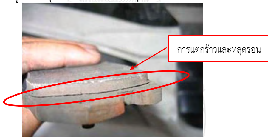
รูปที่ 1.1 การแตกร้าวของผ้าเบรกแบบดิสก์ (ที่มา: http://www.topicstock.pantip.com )
