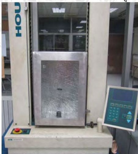
รูปที่ 3.12 การติดตั้งกล่องควบคุมอุณหภูมิกับเครื่องทดสอบแรงกด
