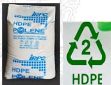
รูปที่ 3.2 พลาสติกประเภทพอลิเอทิลีน ที่มีค่าความหนาแน่นสูง (High Density Polyethylene )
