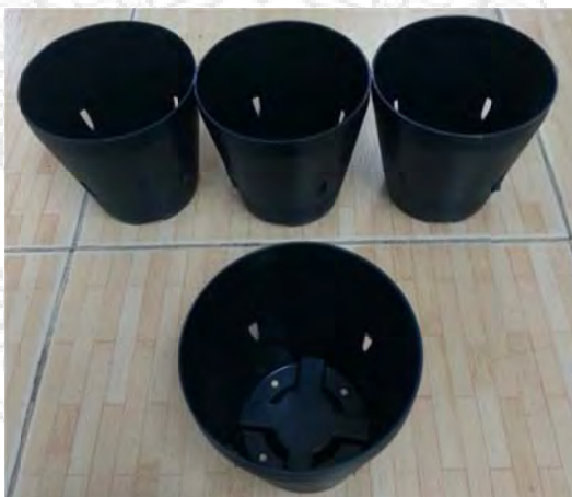
รูปที่ 3.7 กระถางที่ได้จากการฉีด
