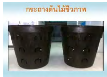
รูปที่ 2.13 กระจ่างตันที่จะทำขึ้นตามผลการวิจัยเรื่อง การพัฒนาเม็ดพลาสติกและคอมพาวด์ ที่มา : วิทยาลัยการปิโตรเลียมจุฬาลงกร กันยายน2553
