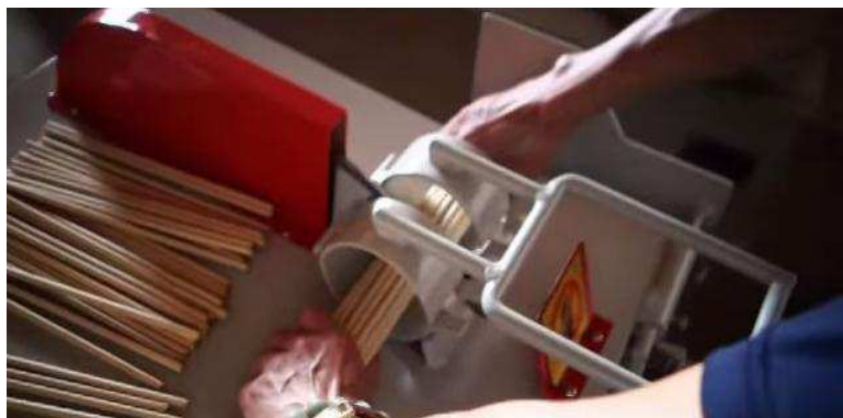
รูปที่ 2.15 เข้าเครื่องแบ่งขนาดความยาวตะเกียบ
