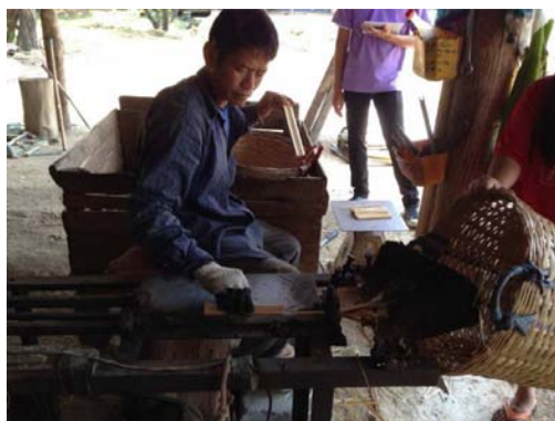
รูปที่ 2.21 ทำการตอกไม้ไผ่ให้ออกมาเป็นตะเกียบ
