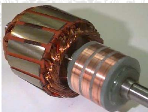
รูปที่ 2.54 ลักษณะของโรเตอร์แบบวาวด์โรเตอร์
