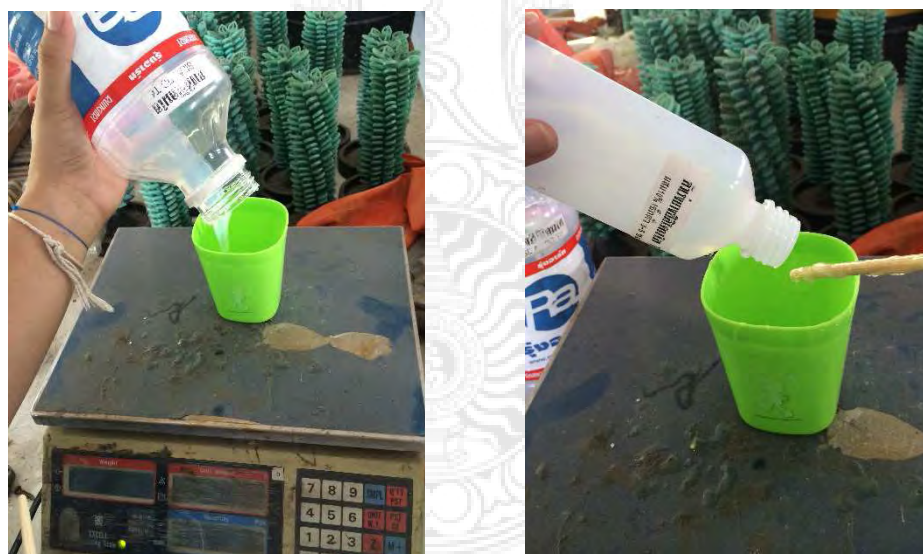
รูปที่ 3.3 การตวงยางซิลิโคนใสกับตัวเร่ง
