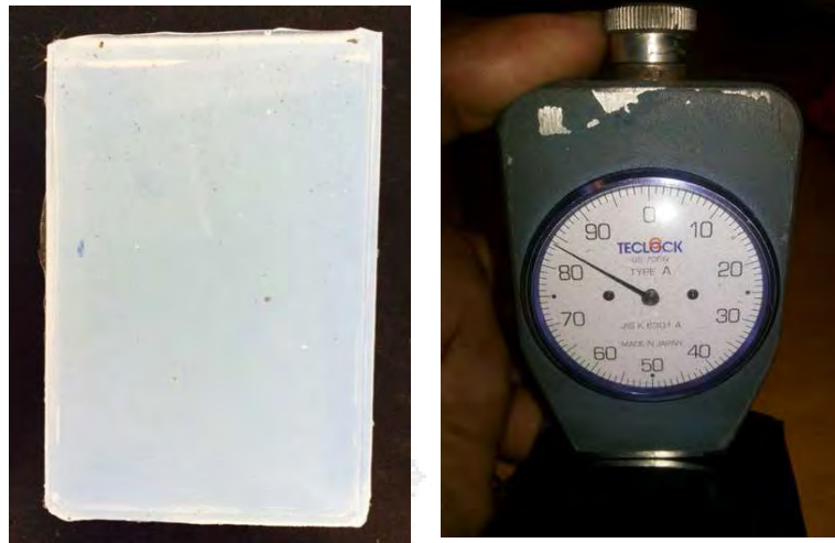
รูปที่ 3.10 การวัดค่าความแข็งของยางซิลิโคนใส
