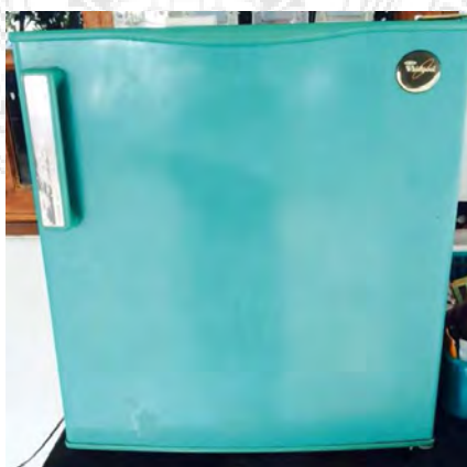
รูปที่ 2.16 ตู้เย็น ตู้เย็นจะช่วยให้ยางซิลิโคนใสมีการแข็งตัวที่เร็วขึ้น ปรับค่าความเย็นที่ 0°C , 5°C , 10°C
