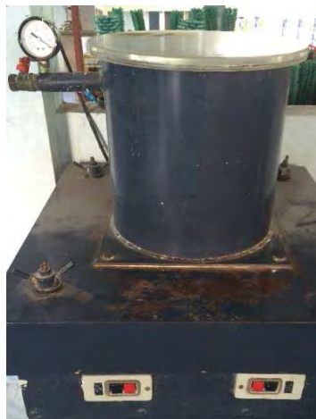
รูปที่ 2.14 เครื่องดูดอากาศ ใช้สำหรับดูดฟองอากาศที่มีในยางซิลิโคนใส
