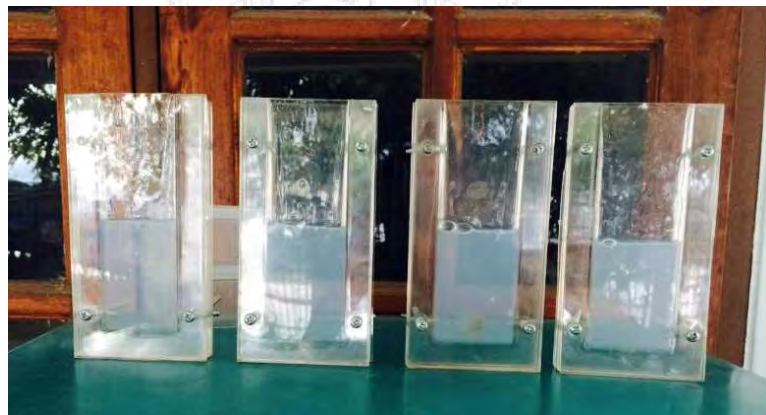
รูปที่ 3.7 การนำยางซิลิโคนพักทิ้งไว้ในอุณหภูมิปกติ
