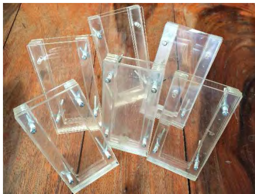
รูปที่ 3.2 การประกอบกรอบสำหรับทำแม่พิมพ์ยาง
