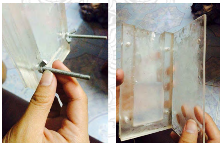
รูปที่ 3.9 การแกะกรอบทำแม่พิมพ์ยาง
