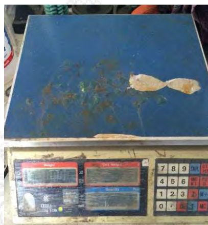
รูปที่ 2.15 เครื่องชั่ง ใช้สำหรับชั่งหรือตวงยางซิลิโคนใสและเพอร์ออกไซด์ในอัตราส่วน 50 : 5
