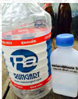
รูปที่ 2.22 ยางซิลิโคนใส - ตัวเร่ง ยางซิลิโคนใส ชนิด Silastic T-4 ใช้สำหรับทำแม่พิมพ์ซิลิโคนใส ตัวเร่ง ชนิดเพอร์ออกไซด์ เพื่อช่วยให้ยางซิลิโคนมีการแข็งตัวที่เร็วขึ้น
