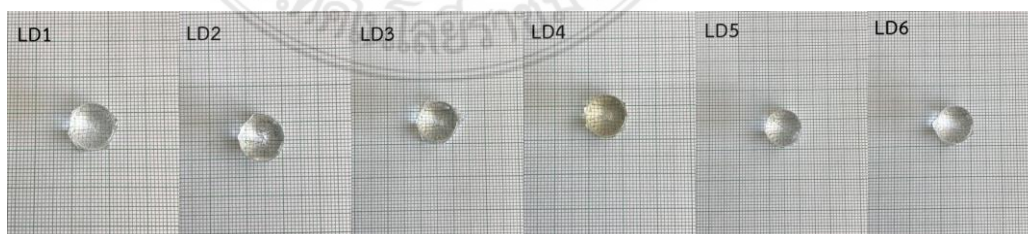
รูปที่ 4.1 แสดงลักษณะทางกายภาพของชิ้นงานแก้ว ทั้ง 6 สูตร
