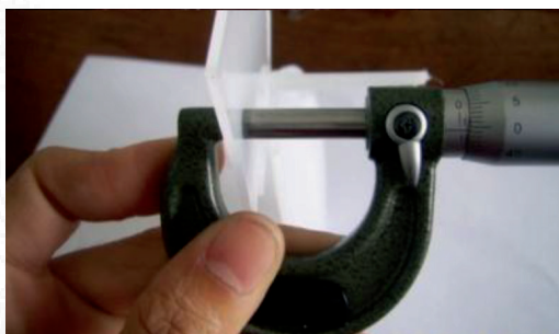
รูปที่ 8 การวัดขนาดความหนาของชิ้นทดสอบ
