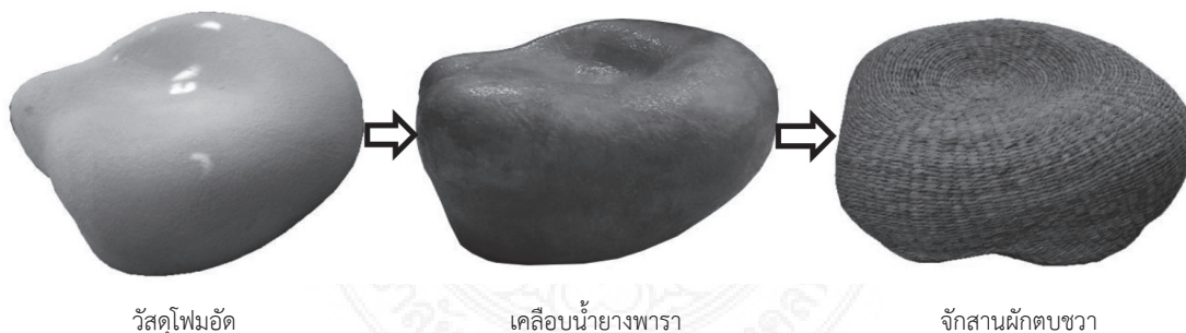
ภาพที่ 6 ผลการทดลองวัสดุทำแม่แบบเครื่องจักสานผักตบชวา
