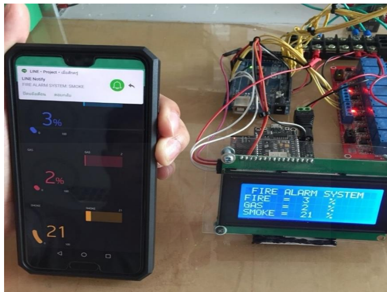
รูปที่ 3.10 แสดงค่าเซ็นเซอร์ที่จับได้ผ่านแอปพลิเคชัน Blynk และแจ้งเตือนผ่านแอปพลิเคชัน Line
