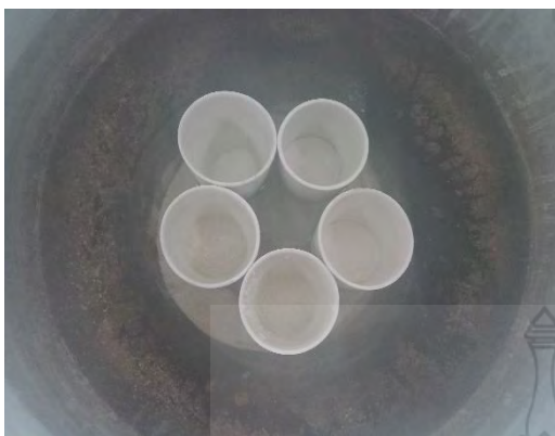
ค) ใส่ผงซิลิกาไว้ในถ้วยแล้วจึงนำไปวางไว้ในภาชนะที่ใส่น้ำที่ต้มจนเดือด
