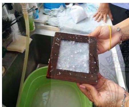
ค) นำกระดาษที่ปั่นเป็นเยื่อเทใส่ใน ตะแกรงขนาด 8 x 8 เซนติเมตร
