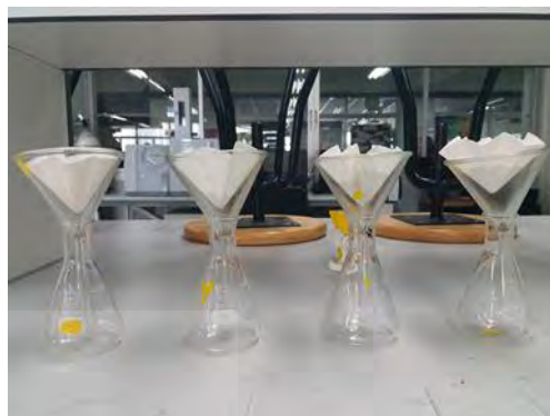
ข) ใส่กระดาษกรองในกรวยกรองที่อยู่บนขวดรูปชมพู่
