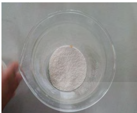
ค) ผงซีลีกาบดละเอียดที่ผ่านการต้มด้วยกรดความเข้มข้น 3 โมลาร์
