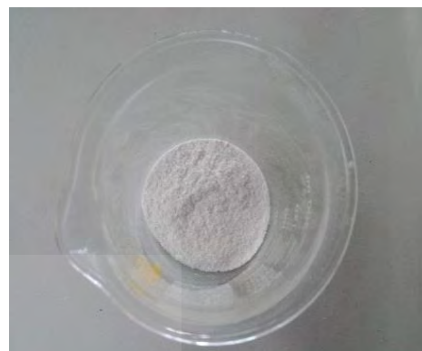
ง) ผงซีลีกาบดละเอียดที่ผ่านการต้มด้วยกรดความเข้มข้น 4 โมลาร์
